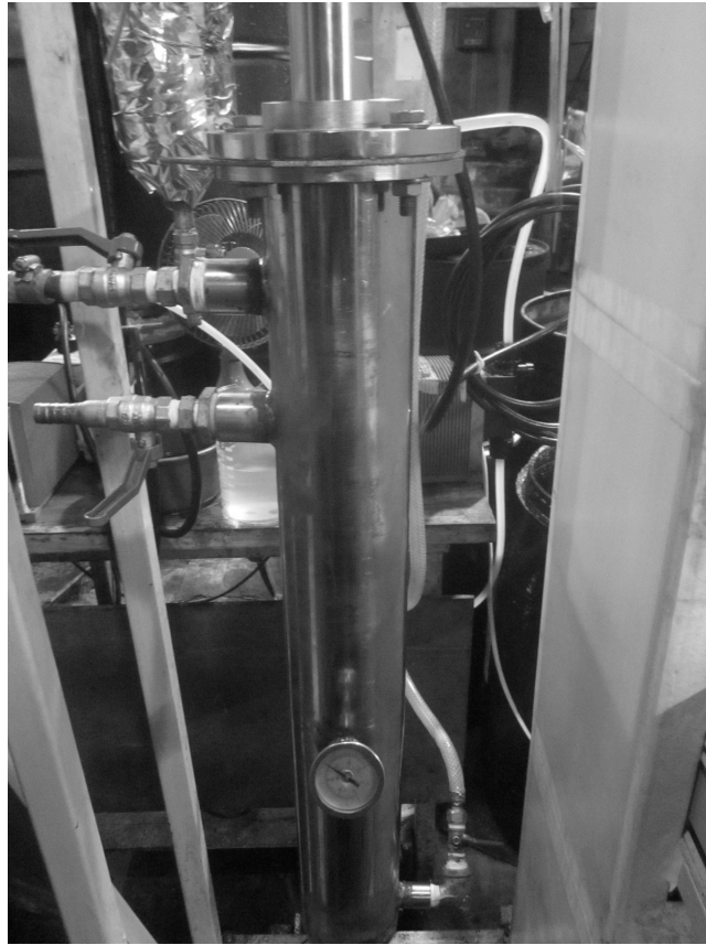
ภาพประกอบที่ 3-3 ถังปฏิกรณ์ที่ใช้ในการทำปฏิกิริยาทรานส์เอสเตอริฟิเคชัน
