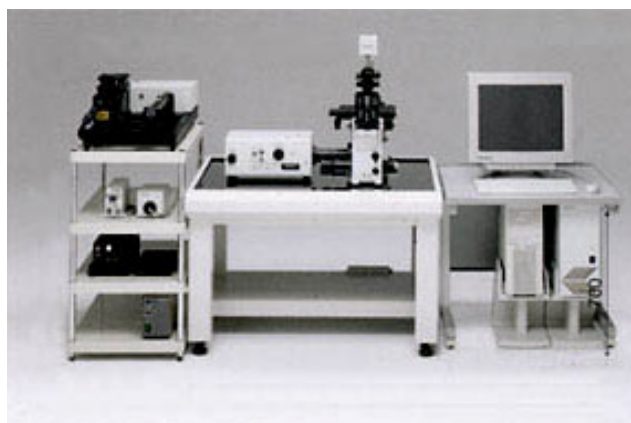
ภาพประกอบที่ 3-2 กล้องจุลทรรศน์ชนิด Confocal Laser Scanning Microscope (CLSM)
