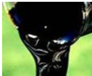
รูปที่ 3.1 ยางมะตอยชนิดเพนนีเทชัน เกรด 60/70
