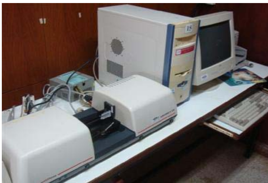
รูปที่ 12 เครื่องยูวี-วิสิเบิลสเปกโทรโฟโตมิเตอร์ รุ่น SPECORD ® S100 Analytik Jena GmbH, Germany
