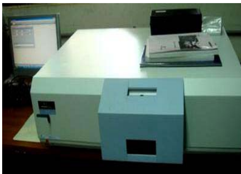
รูปที่ 14 เครื่องลูมิเนสเซนซ์สเปกโทรโฟโตมิเตอร์ รุ่น LS 55 PerkinElmer, U.S.A.
