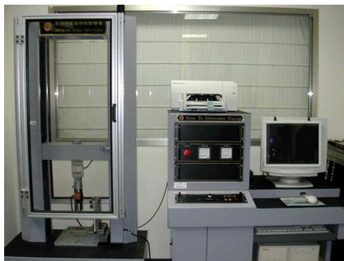
ภาพที่ 3.7 เครื่องทดสอบค่าความต้านทานแรงดึง (Universal Testing Machine)
