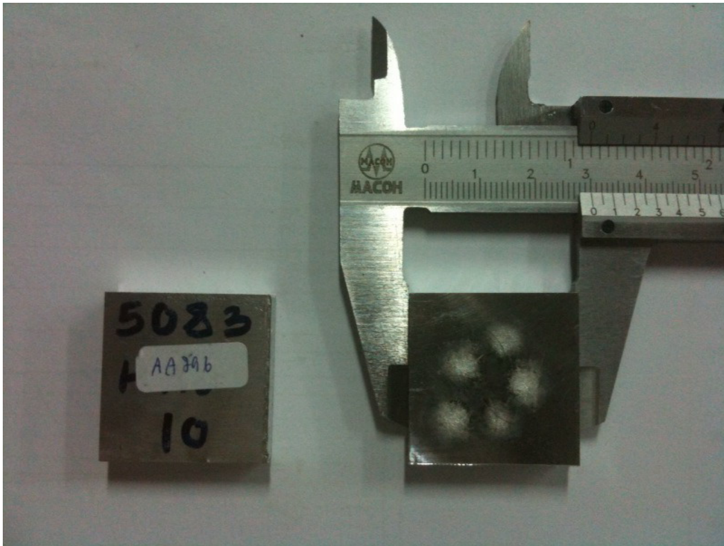
ภาพที่ 3.15 ชิ้นงานภายหลังการทดสอบองค์ประกอบทางเคมี
