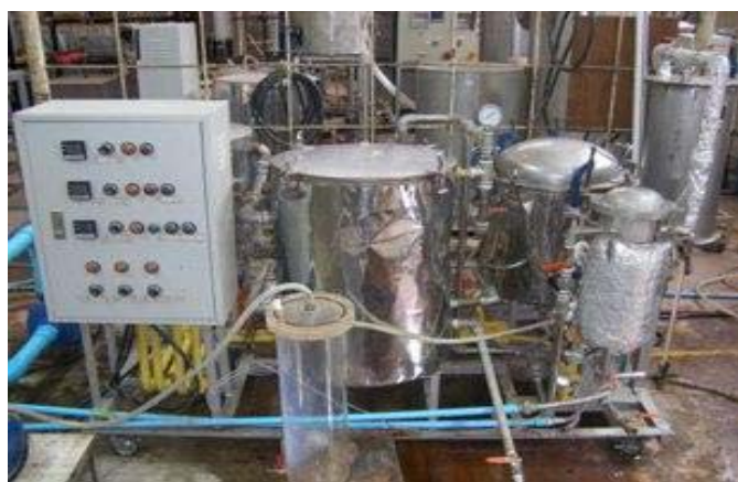
ภาพประกอบ 3-3 ภาพถ่ายชุดสกัดแบบเบบท์ขนาดโรงงานจำลอง
