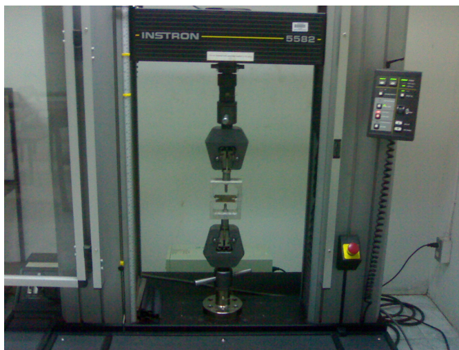
รูปที่ 3.22 การทดสอบความแข็งแรงดึง
