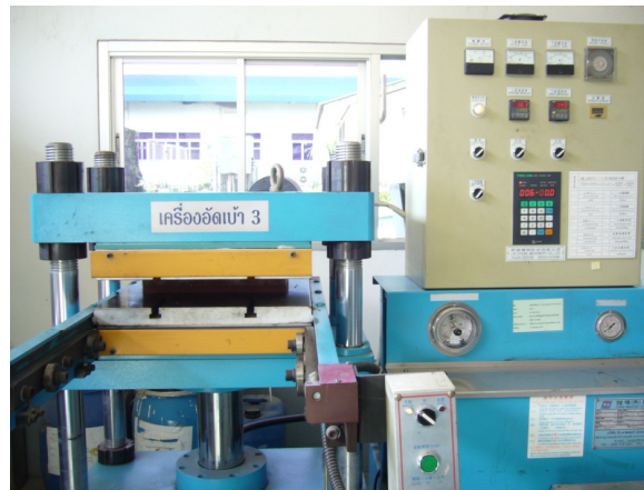
รูปที่ 3.9 เครื่องอัดแม่พิมพ์ไฮดรอลิก (Compression molding machine)
