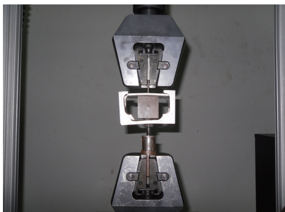
รูปที่ 3.31 การทดสอบความยืดหยุ่นของตะปูเกลียว (ด้านขอบ)
