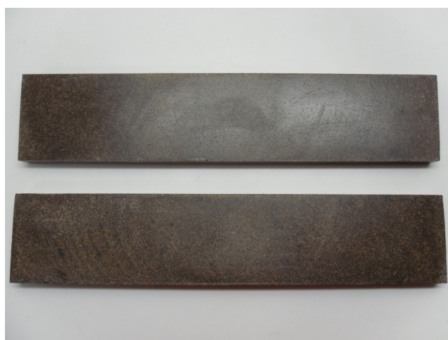
รูปที่ 3.26 ไม้พลาสติกต้นแบบหลังการขัดแต่งผิว
