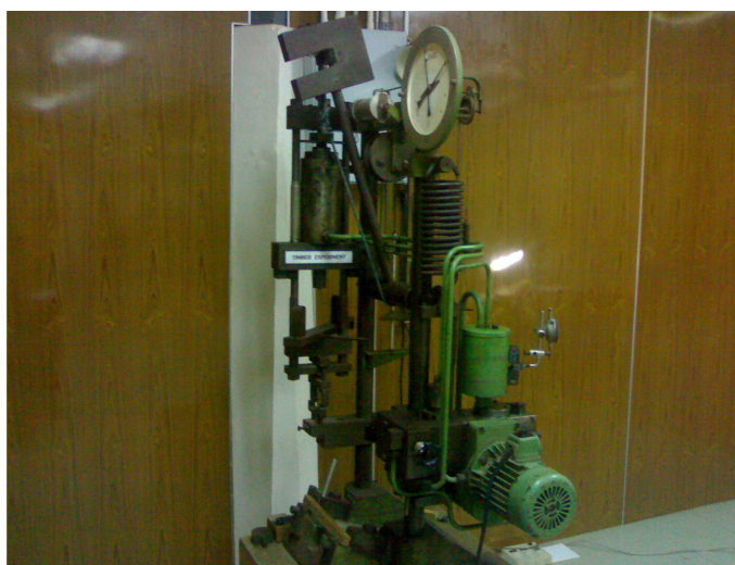
รูปที่ 3.24 การทดสอบการดูดซับพลังงานแรงกระแทก
