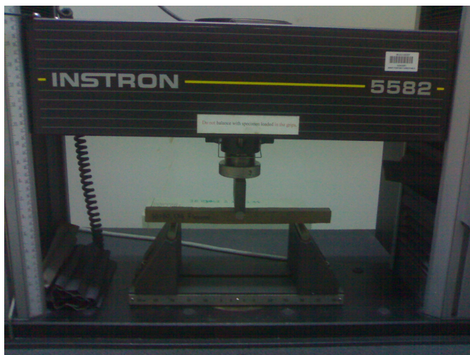
รูปที่ 3.20 การทดสอบความแข็งแรงดัด
