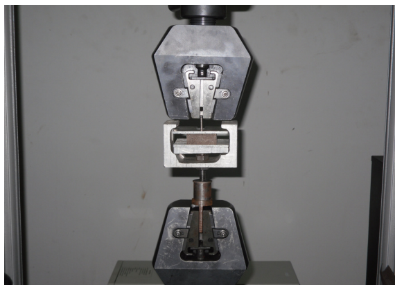
รูปที่ 3.30 การทดสอบความยืดหยุ่นของตะปูเกลียว (ด้านผิวหน้า)
