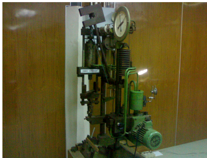
รูปที่ 3.12 เครื่องทดสอบไม้ (Universal wood testing machine)
