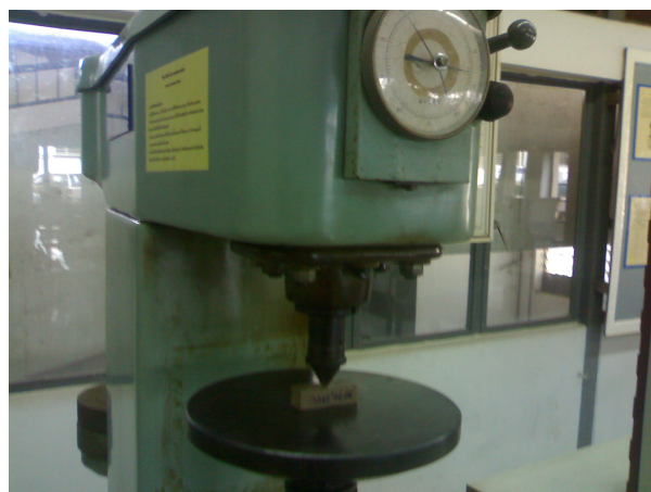
รูปที่ 3.10 เครื่องทดสอบความแข็ง (Hardness testing machine)
