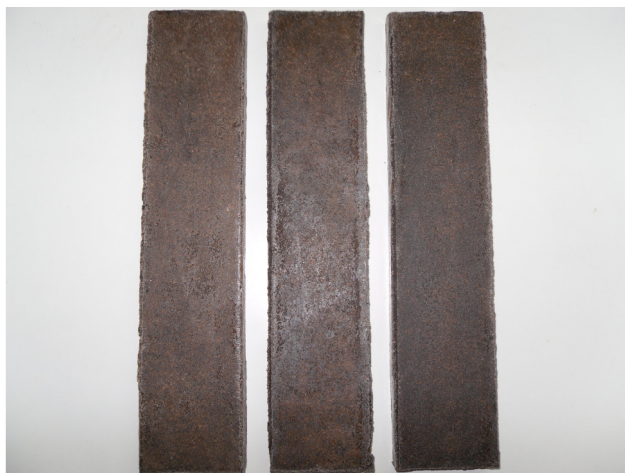
รูปที่ 3.25 ไม้พลาสติกต้นแบบก่อนการขัดแต่งผิว
