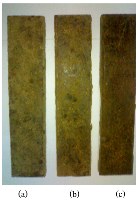
รูปที่ 3.18 ชิ้นงานไม้พลาสติก สัดส่วนผงไม้ปาล์ม : HDPE :MA ที่ 50:47:03
