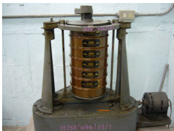
รูปที่ 3.7 เครื่องร่อน (Testing sieve shaker)
