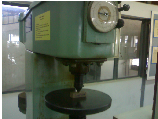
รูปที่ 3.19 การทดสอบความแข็ง
