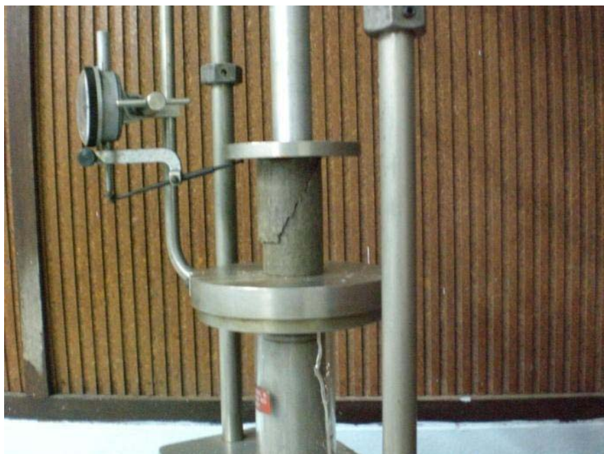
รูปที่ 3.11 การทดสอบแรงเฉือนแบบไม่ถูกจำกัด (Unconfined Compression Test)
