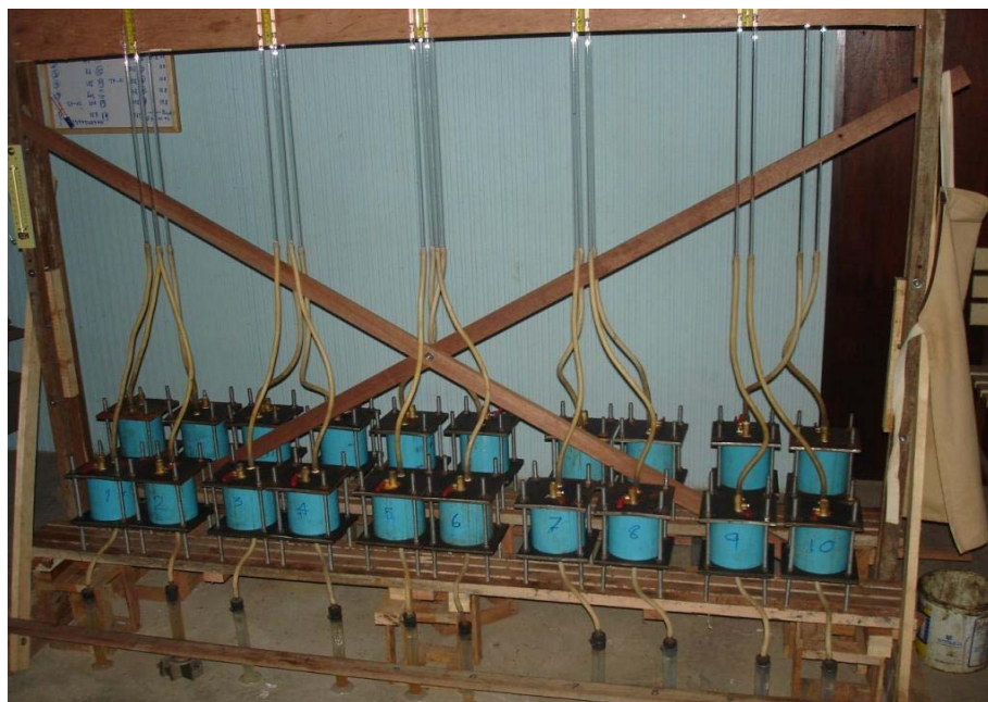
รูปที่ 3.4 การติดตั้งชุดทดสอบสัมประสิทธิ์การยอมให้น้ำซึมผ่าน จำนวน 20 ชุด
