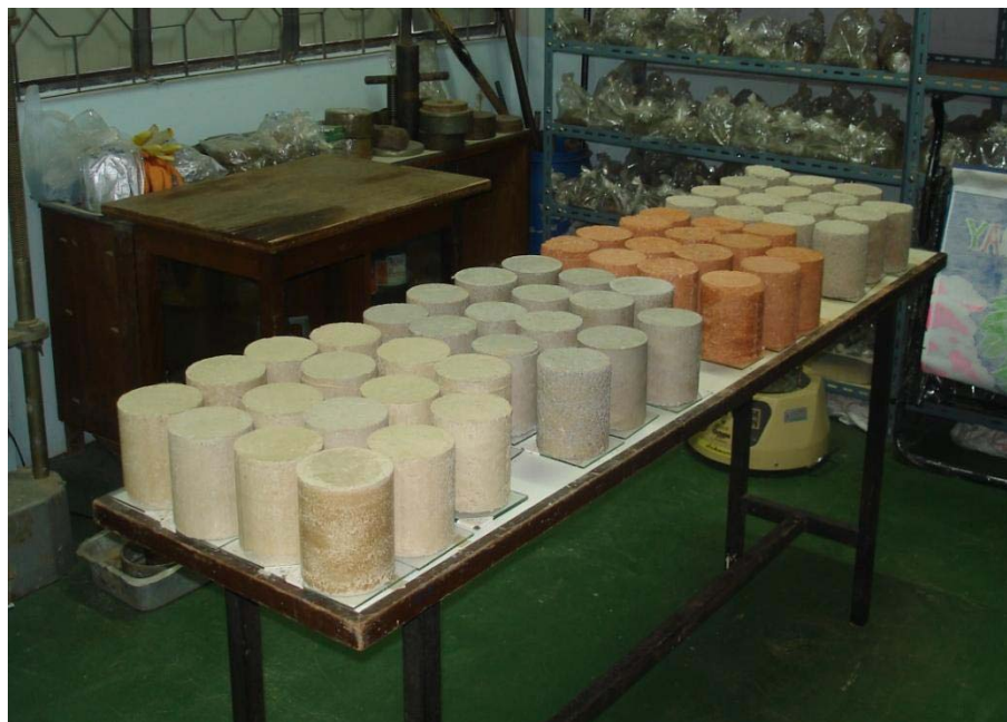
รูปที่ 3.9 การทดสอบการหดตัวเชิงปริมาตรของดินตัวอย่าง
