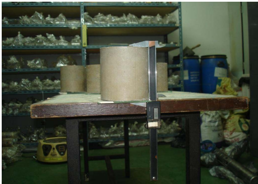
รูปที่ 3.10 การวัดขนาดตัวอย่างด้วย Electronic Digital Caliper
