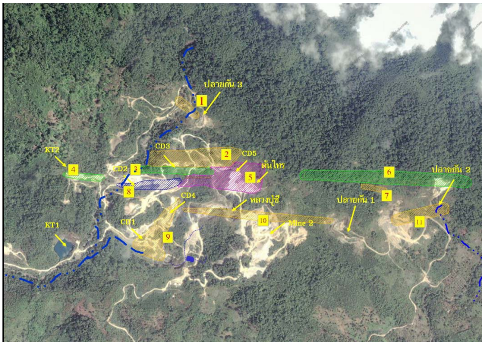
รูปที่ 2.2 ภาพถ่ายดาวเทียมบริเวณแหล่งแร่ซ้อนภาพกับแบบจำลองแนวสายแร่ในแหล่งแร่ (ธงชัยและคณะ 2552, pointasia 2009)
