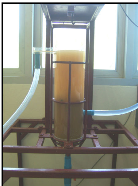
รูปที่ 3.11 อิลูตริเอเตอร์ที่ออกแบบและสร้างขณะทำการศึกษา
