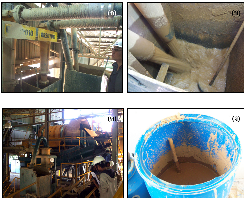
รูปที่ 2.2 โรงลอยแร่บริษัทผาแดงอินดัสทรีจำกัด (มหาชน) ก) ไฮโดรไซโคลนชุดที่ 1 ข) ส่วนไหลออกจากไฮโดรไซโคลนชุดที่ 1 ค) ภายในโรงแต่งแร่ ง) หางแร่ส่วนที่นำมาทำวิจัย
