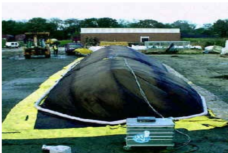
รูปที่ 2.9 กองหมักแบบใช้เครื่องเติมอากาศ (Aerated Static Pile)
