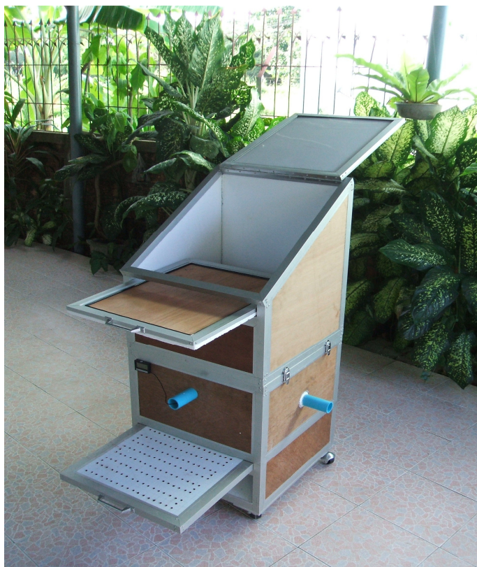
รูปที่ 4.40 ถังหมักมูลฝอยอินทรีย์แบบที่ 3 ต้นแบบจริง
