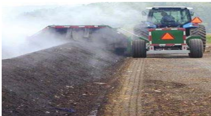
รูปที่ 2.6 การพลิกกลับกองปุ๋ยหมักแบบ Windrow โดยใช้เครื่องจักรกล
