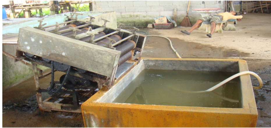
ภาพเครื่องจักรรีดขาง ของนักลงทุนผลิตขางแผ่นดิบขนาดกลาง
