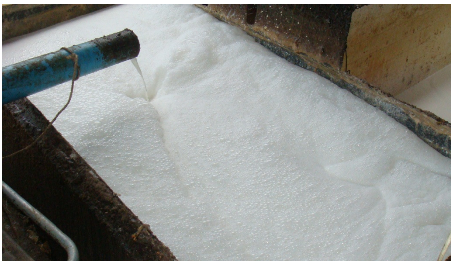
ภาพท่อเก็บรวบรวมน้ำยางสด ของนักลงทุนผลิตยางแผ่นดิบขนาดกลาง
