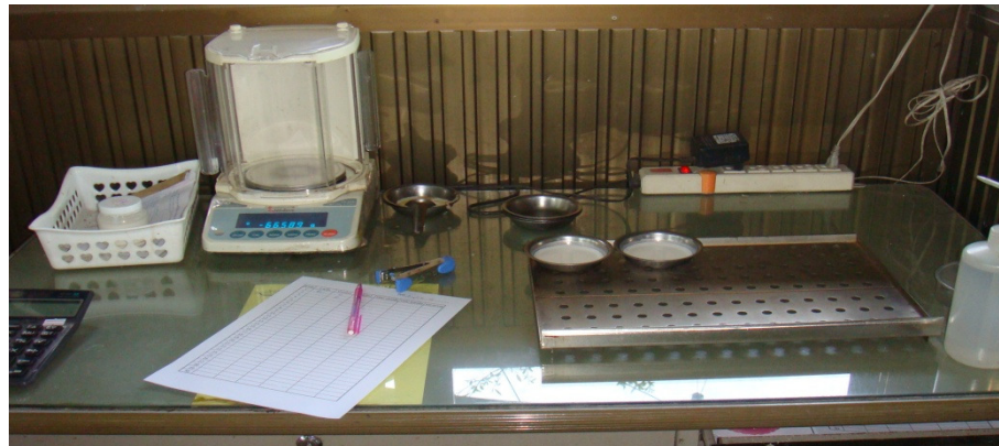
ภาพตาชั่งน้ำหนักขางเพื่อหา % DRC ของนักลงทุนผลิตยางแผ่นดิบขนาดใหญ่
