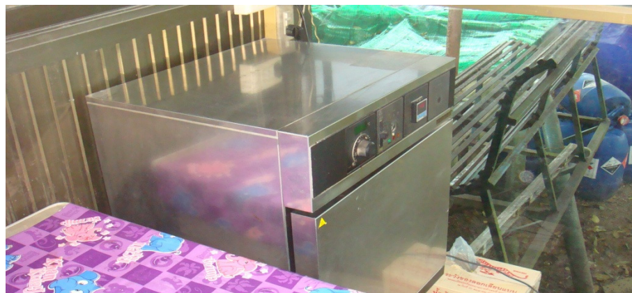
ภาพตู้อบยางตัวอย่างเพื่อหา % DRC ของนักลงทุนผลิตยางแผ่นดิบขนาดใหญ่
