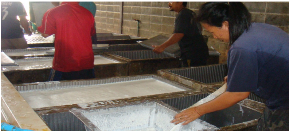
ภาพการเทน้ำยางสด ลงในตะกของนักลงทุนผลิตยางแผ่นดิบขนาดใหญ่
