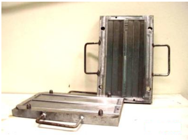
รูปที่ 423 แสดงลักษณะแม่พิมพ์แผ่นรองรับด้านหลัง
