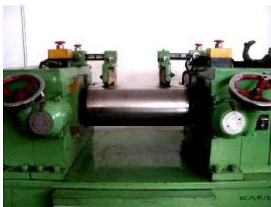
(ก) เครื่องบดยาง 2 ลูกกลิ้ง (Two roll mill) (ข) เครื่องอัดเบ้า (Compression molding machine) รูปที่ 315 แสดงเครื่องมือที่ใช้ในการบดยางและอัดขึ้นรูป
