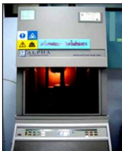
(ก) เครื่องทดสอบการวัลคาไนซ์ของยาง (Moving Die Rheometer, MDR) (ข) เครื่องทดสอบความหนืดของยาง (Mooney viscometer)
