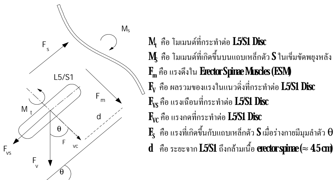
รูปที่ 35 แสดงลักษณะของแรงและโมเมนต์ที่เกิดขึ้นบน L5/S1 Disc และบนแถบเหล็กรูปตัว S
