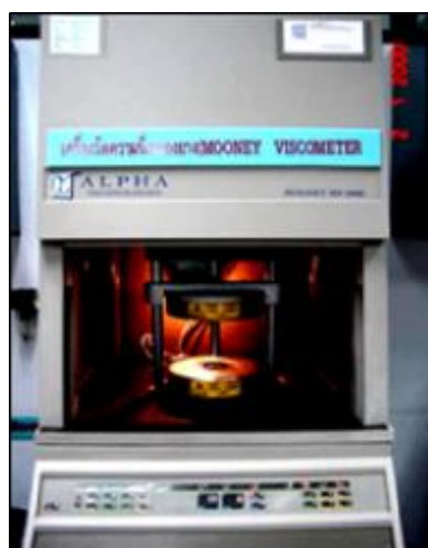
(ก) เครื่องทดสอบการวัลคาไนซ์ของยาง (Moving Die Rheometer, MDR) (ข) เครื่องทดสอบความหนืดของยาง (Mooney viscometer)
