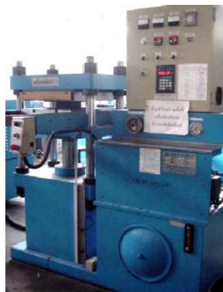
(ก) เครื่องบดยาง 2 ลูกกลิ้ง (Two roll mill) (ข) เครื่องอัดเบ้า (Compression molding machine) รูปที่ 315 แสดงเครื่องมือที่ใช้ในการบดยางและอัดขึ้นรูป
