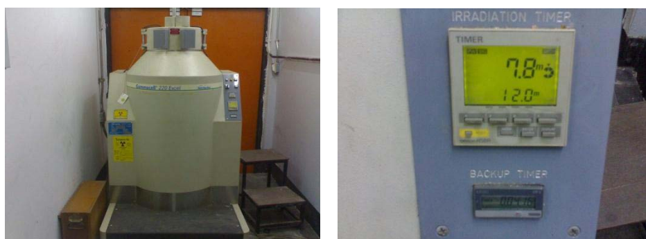
รูปที่ 3.3 เครื่องฉายรังสีแกมมา รุ่น Gammacell 220 Excel ที่ศูนย์ฉายรังสีแกมมา
