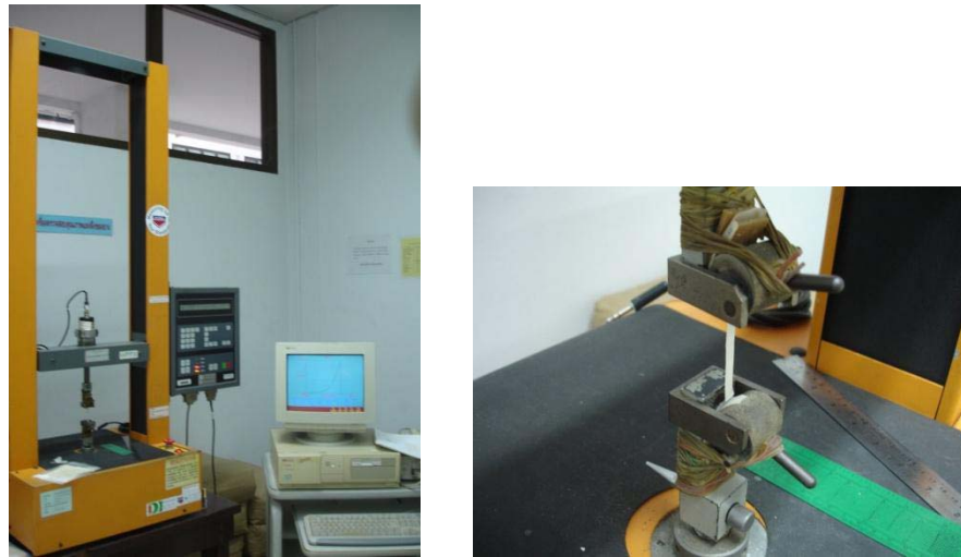
รูปที่ 3.8 เครื่องทดสอบแรงดึง (universal testing machine) ยี่ห้อ LLOYD instrument รุ่น LR10K ที่ใช้ในการทดสอบสมบัติความต้านทานแรงดึง
