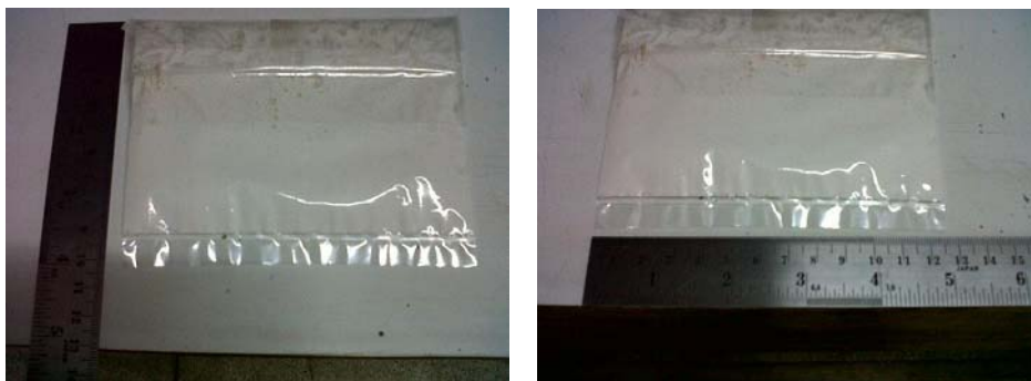
รูปที่ 3.4 ถังพลาสติก สำหรับใส่น้ำยางเพื่อฉายรังสียูวี
