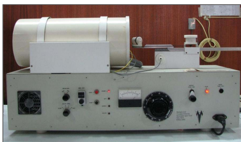
ภาพประกอบที่ 2.9 เครื่องลบล้างอำนาจแม่เหล็กแบบสนามสลับ ยี่ห้อ Molspin
