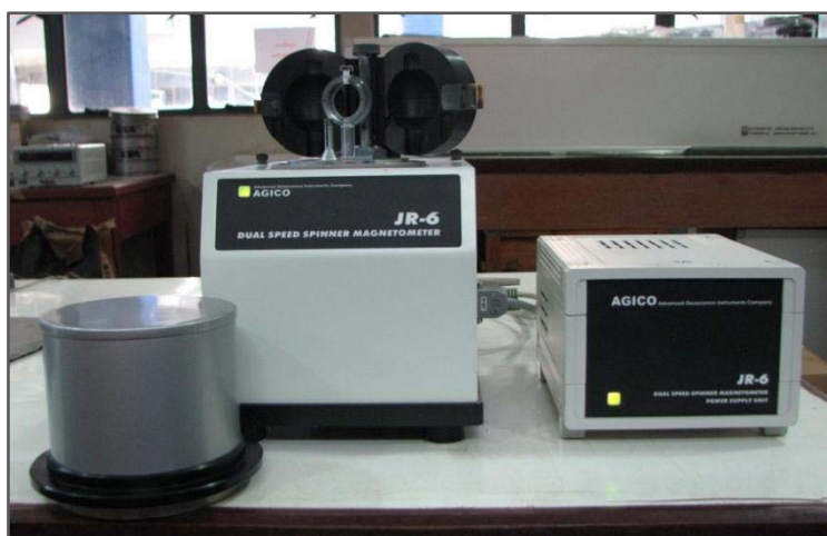
ภาพประกอบที่ 2.8 เครื่องแมกนีโทมิเตอร์แบบหมุนยี่ห้อ AGICO รุ่น JR-6
