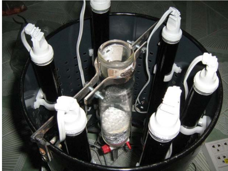
รูปที่ 4.1 เครื่องมือในการทดสอบการฆ่าเชื้อ E.coli และสลายกรดฮิวมิก (ด้านบน)
