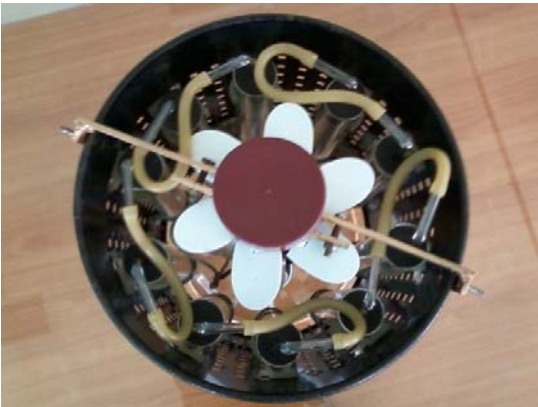
รูปที่ 4.3 ชุดต้นแบบเครื่องปฏิกรณ์ ก) หลอดแก้ว ข) หลอดไฟ ค) ภาพจากด้านบน ง) ภาพชุดปฏิกรณ์แบบสมบูรณ์
