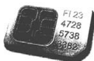
ภาพที่ 2.3 ตัวอย่าง SIM Card เก็บข้อมูลหมายเลขโทรศัพท์
