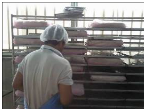
ภาพประกอบที่ 3.5 วัตถุดิบซูริมิถูกแกะจากกล่องมาเก็บบนชั้นละลายปลา
