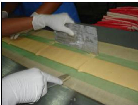
ภาพประกอบที่ 3.8 การตัดฟองเต้าหู้ตามความยาวที่กำหนด
