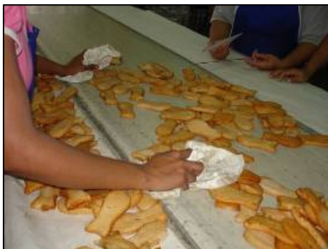
ภาพประกอบที่ 3.16 นำเต้าหู้ที่สลัดน้ำมันแล้วขึ้นสายพานบรรจุและซับมันด้วยกระดาษ
