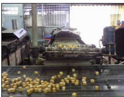
ภาพประกอบที่ 3.13 เต้าหู้ที่ผ่านการทอดถูกลำเลียงออกจากเครื่องทอด
