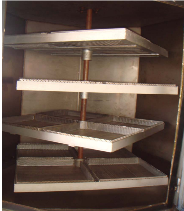
รูปที่ 4-2 แสดงถาดบรรจุสินค้า 16 ถาดภายในเตาอบรมควัน
