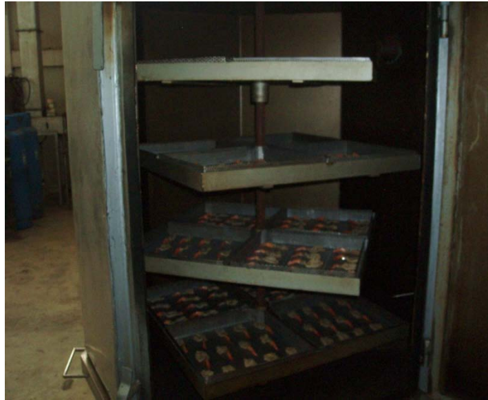
รูปที่ 4-3 แสดงการอบกุ้งรมควันเย็นด้วยเตาอบรมควัน
