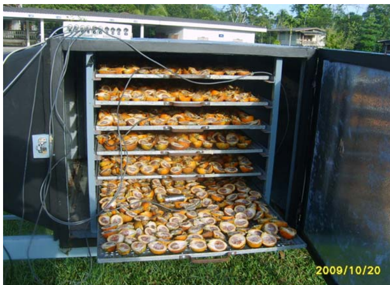
รูปที่ ๒ แสดงภาพถ่ายผลหมากผ่าซีกที่บรรจุในห้องอบแห้งขณะทำการทดลอง
