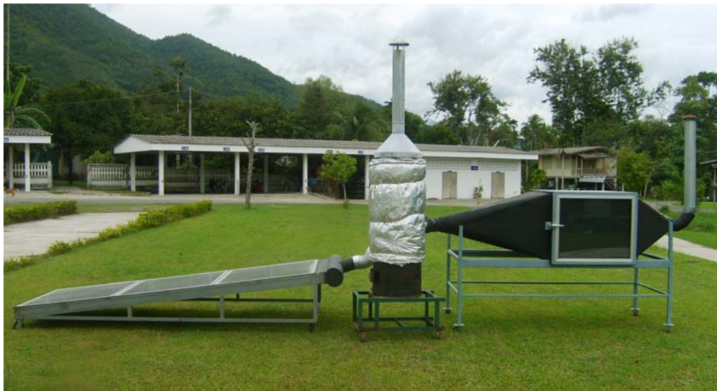
รูปที่ 3.13 แสดงภาพถ่ายของเครื่องอบแห้งมากโดยใช้พลังงานร่วมแสงอาทิตย์และชีวมวล
