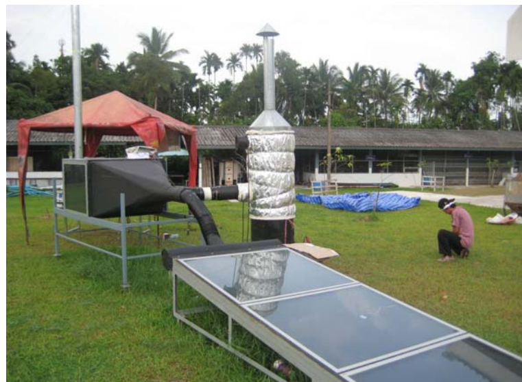
รูปที่ ๖ แสดงภาพถ่ายขณะทดลองอบแห้งหมาก โดยใช้พลังงานร่วมแสงอาทิตย์และชีวมวล
