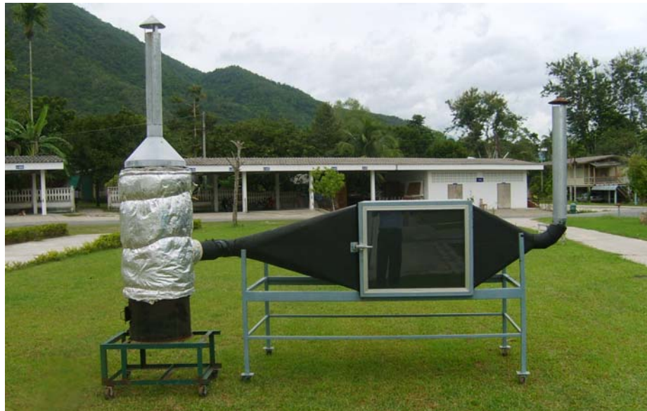
รูปที่ 3.10 แสดงภาพถ่ายของเครื่องอบหมากโดยใช้พลังงานชีวมวลอย่างเดียว
