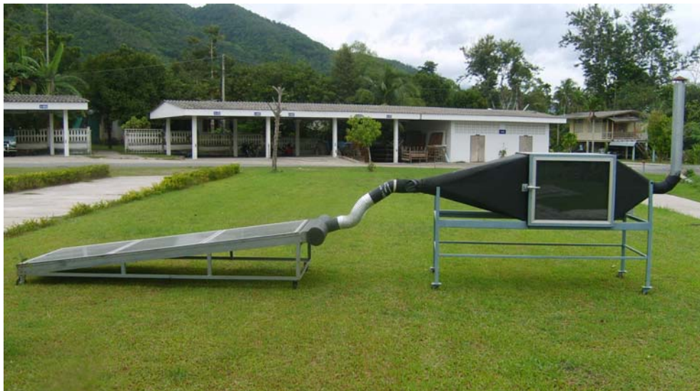
รูปที่ 3.7 แสดงภาพถ่ายของเครื่องอบหมากโดยใช้พลังงานแสงอาทิตย์อย่างเดียว
