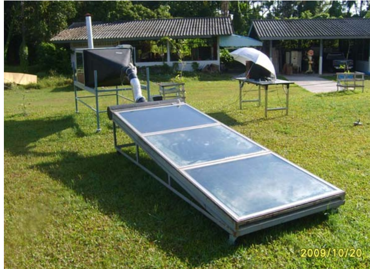
รูปที่ 3 แสดงภาพถ่ายขณะทดลองอบแห้งหมากโดยใช้พลังงานแสงอาทิตย์อย่างเดียว
