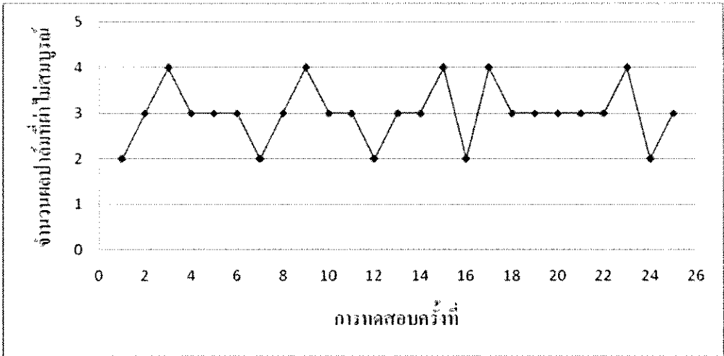
รูปที่ 4.4 แผนภูมิควบคุมคุณภาพ np-chart ของการผ่าผลปาล์มพันธุ์เทเนอร์่า โดยใช้ใบเลื่อยขนาด 7.5 นิ้ว 40 ฟัน ความหนาของฟัน 2.5 มม.
