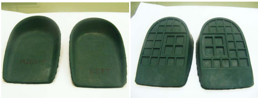
รูปที่ 4.26 ต้นแบบอุปกรณ์รองส้นเท้า model II ที่ขึ้นรูปได้
