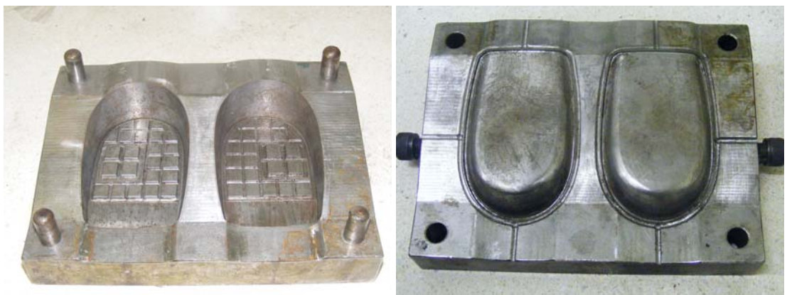
รูปที่ 4.25 แม่พิมพ์ต้นแบบอุปกรณ์รองส้นเท้า model II
