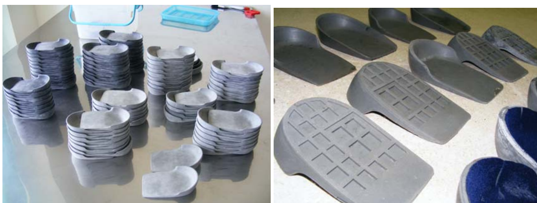
รูปที่ 4.29 ต้นแบบอุปกรณ์รองส้นเท้า model III ที่ขึ้นรูปได้
