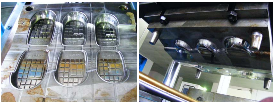
รูปที่ 4.28 แม่พิมพ์ต้นแบบอุปกรณ์รองส้นเท้า model III
