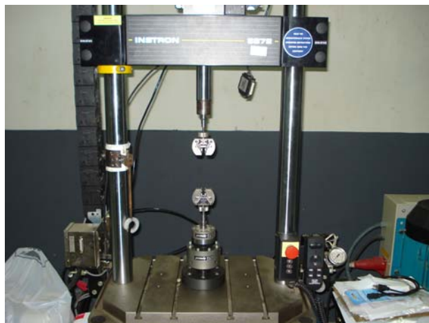
รูปที่ 3.9 เครื่องทดสอบความแข็งแรงวัสดุ (Universal testing machine)
