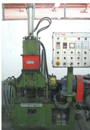
รูปที่ 3.1 เครื่องผสมยางแบบปิด (Kneader)
