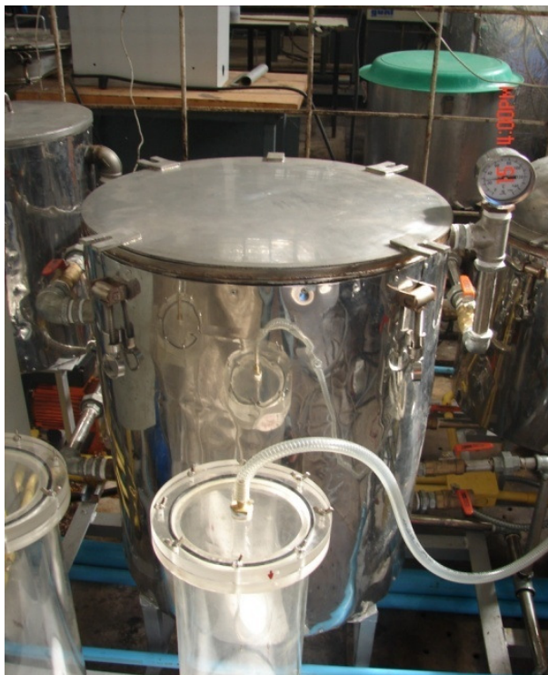
ภาพประกอบที่ 10 แสดงถังสกัดที่ประกอบด้วยชุดสกัดแบบแบทช์
