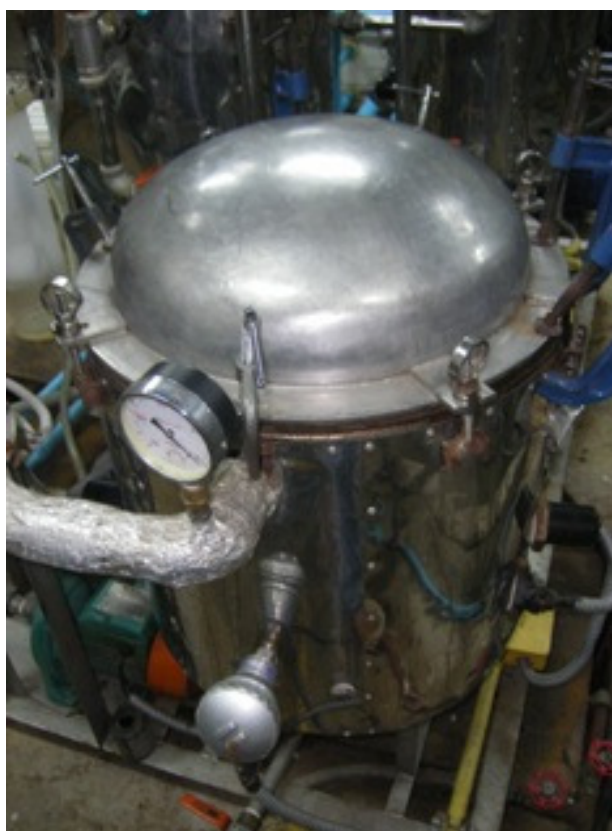
ภาพประกอบที่ 14 ถังระเหยขนาดใหญ่ที่ประกอบด้วยชุดสก็ดแบบเบทซ์
