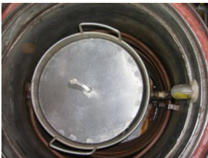
ภาพประกอบที่ 13 ลักษณะการบรรจุวัตถุดิบลงด้านในของถังสกัดที่ประกอบด้วยชุดสกัดแบบเบทซ์
