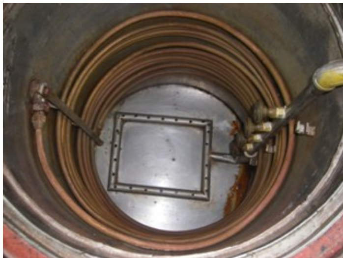
ภาพประกอบที่ 12 ด้านในของถังสกัดที่ประกอบด้วยชุดสกัดแบบเบทซ์
