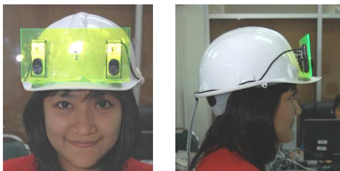
รูปที่ 3-7 กล้องสเตอริโอที่จัดทำขึ้นเมื่อนำมาสวมใส่
