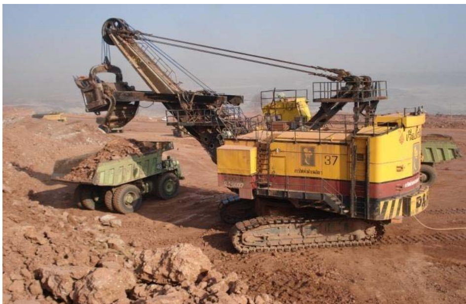
รูป 1.1 รถขุดไฟฟ้า (Electric Shovel) ยี่ห้อ P&H รุ่น 2100 BL
