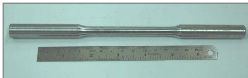
รูปที่ 2.6 ชิ้นทดสอบความแข็งแรงล้า
