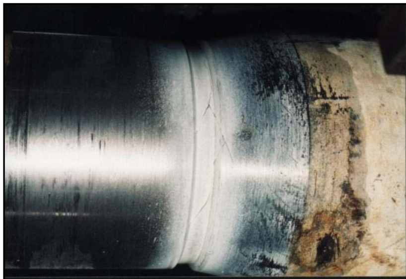
รูปที่ 3.2 บริเวณป่าเพลลาแบบโค้งซึ่งเป็นบริเวณเริ่มต้นของรอยแตก
