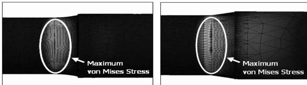
รูปที่ 1.53 ผลการวิเคราะห์ค่าความเค้นของบ่าเพลาลูกหีบแบบลาดเอียงและบ่าเพลาลูกหีบแบบโค้ง
