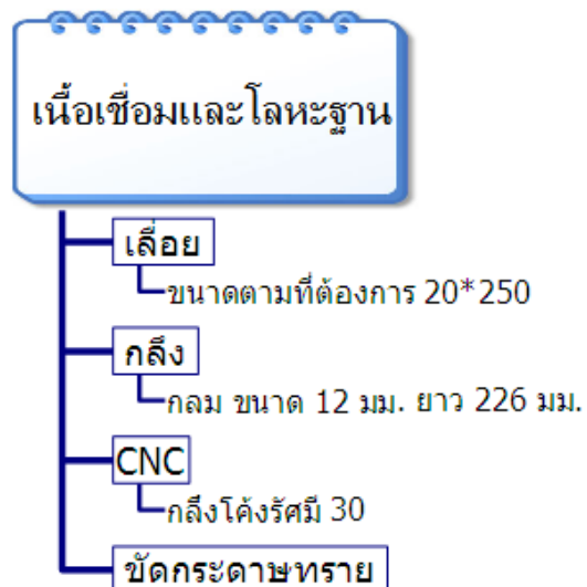
รูปที่ 2.15 ขั้นตอนการเตรียมชิ้นงานทดสอบ
