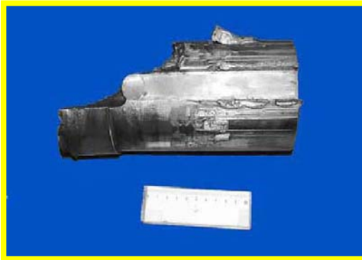
รูปที่ 1.21 ลักษณะการชำรุดของเพลลา
