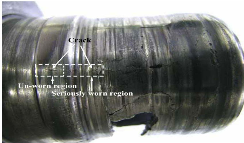
รูปที่ 1.29 ความเสียหายที่เกิดบริเวณผิว sleeve bearing
