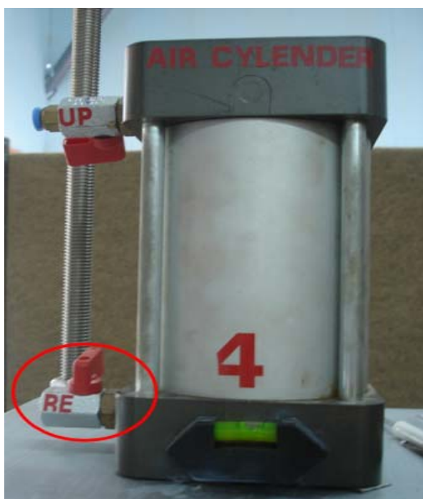
ภาพประกอบที่ ข-13 แสดงการปิดวาล์วล่าง (RE) ของกระบอกกลม
