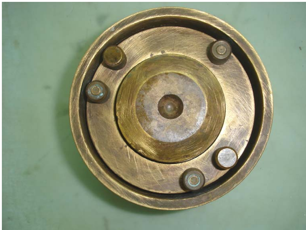
ภาพประกอบที่ ข-8 แสดงนำฝาปิดวางลงใน Consolidation Cell
