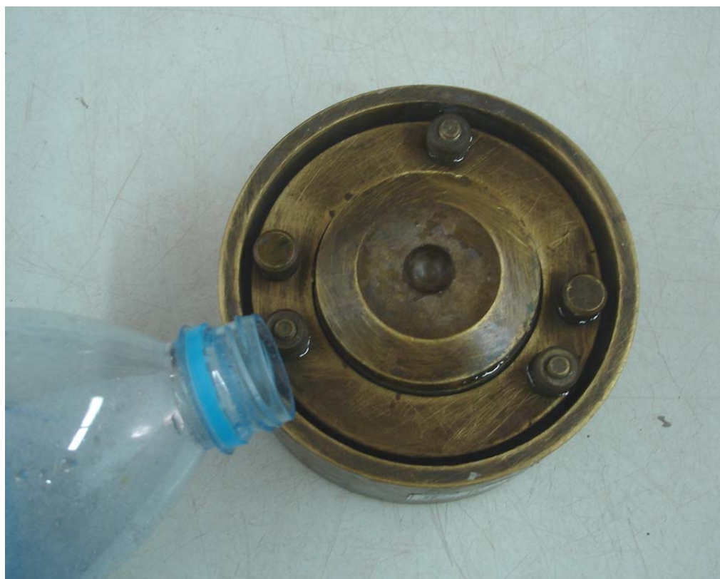
ภาพประกอบที่ ข-9 แสดงการเติมน้ำลงใน Consolidation cell จนท่วมดินตัวอย่าง
