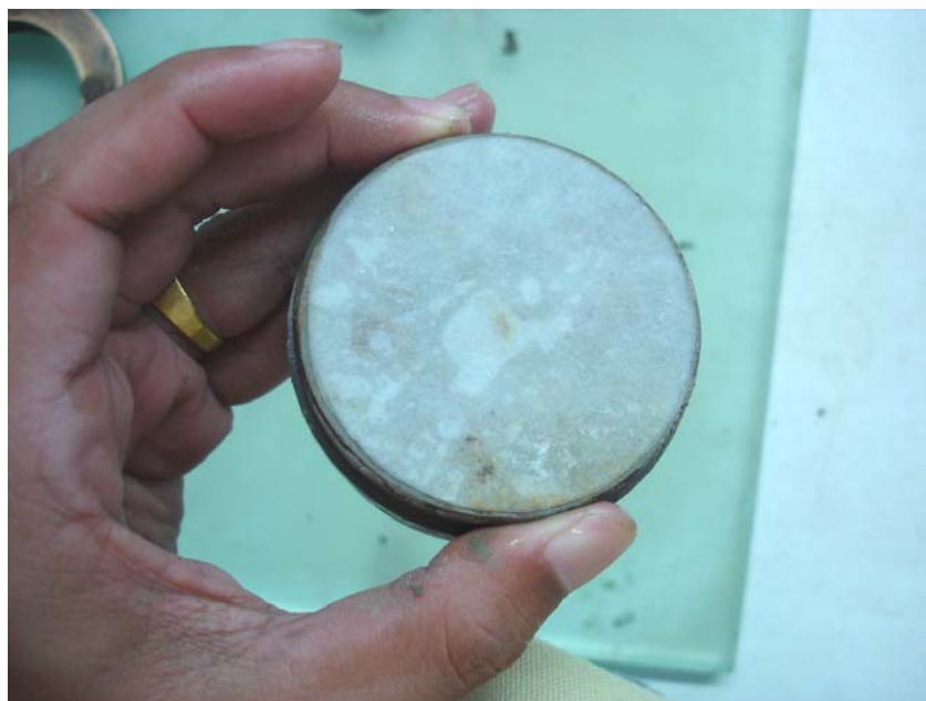
ภาพประกอบที่ ข-3 แสดงการนำกระดาษกรองปิดดินตัวอย่างทั้งด้านบนและด้านล่าง
