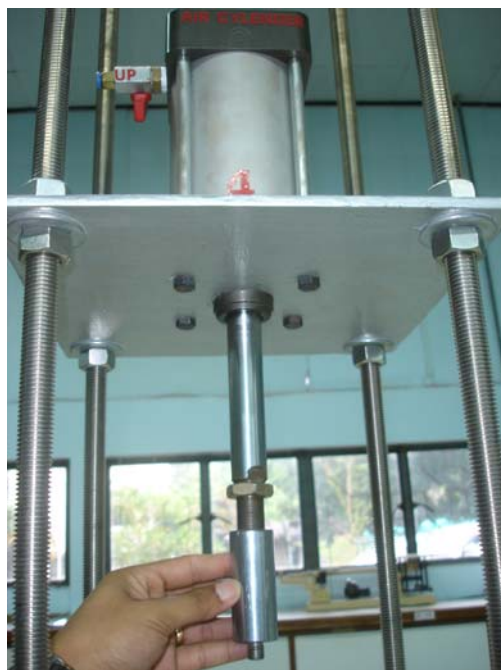
ภาพประกอบที่ ก-3 แสดงการต่อแท่งสแตนเลสกลิ้งเข้ากับ Air cylinder
