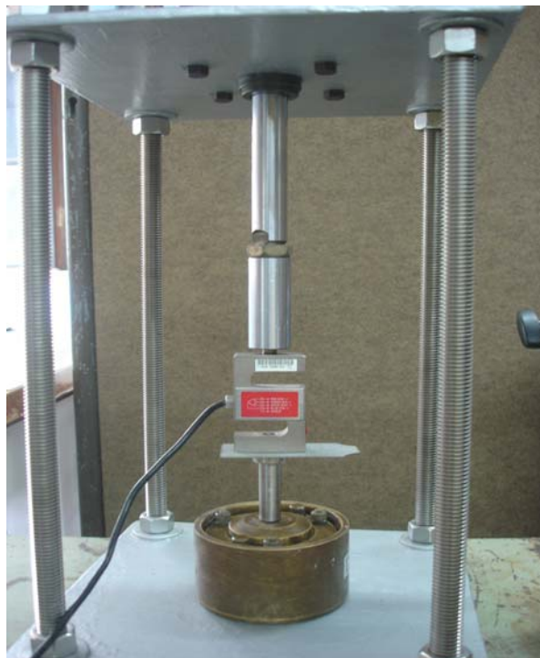
ภาพประกอบที่ ข-12 แสดงการติดตั้งกระบอกกลมมาสัมผัส Consolidation cell
