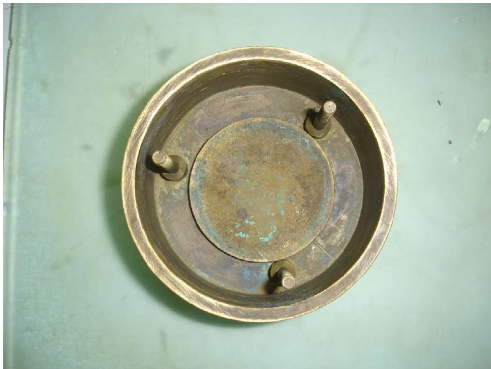
ภาพประกอบที่ ข-4 แสดงการนำ Bottom Porous Stones วางลงใน Consolidation Cell
