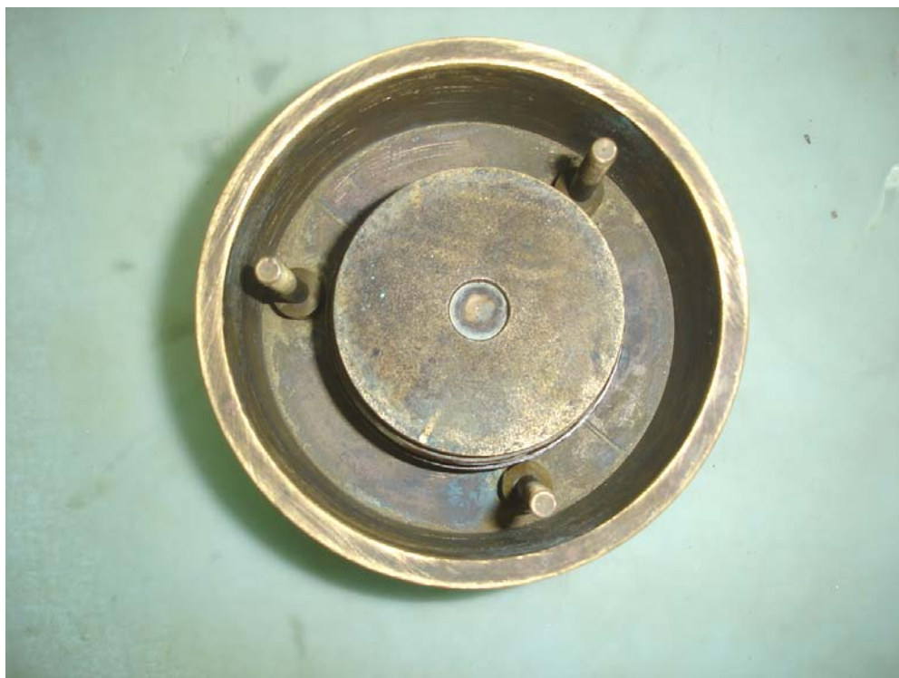
ภาพประกอบที่ ข-6 แสดงการนำ Top Porous Stones วางลงใน Consolidation Cell
