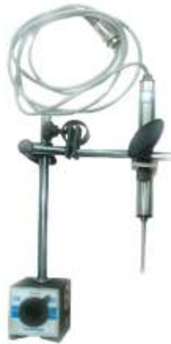
ภาพประกอบที่ 3.13 อุปกรณ์ Displacement Transducer พร้อมแท่นจับแม่เหล็ก
