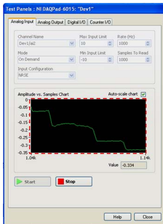
ภาพประกอบที่ ข-18 แสดงตัวอย่างกราฟเมื่อทำการทดสอบสัญญาณ Input Channel
