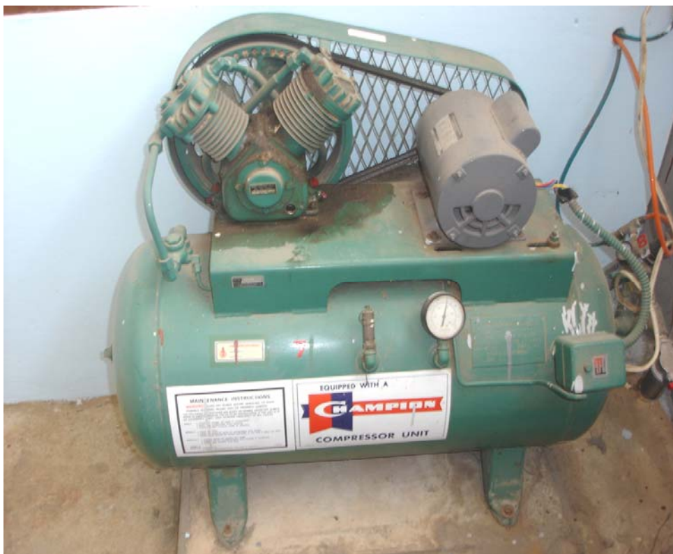
ภาพประกอบที่ ก-9 แสดงภาพปั๊มลมและการตรวจสอบแรงดันในถัง
