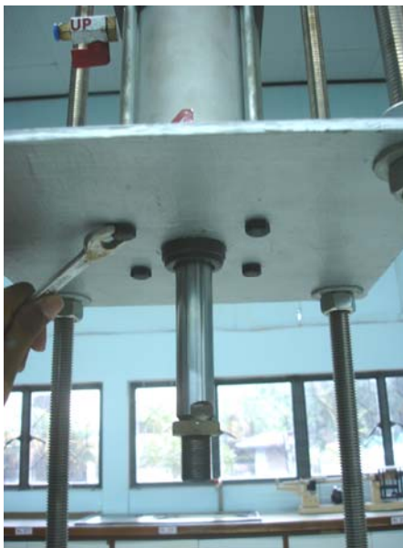
ภาพประกอบที่ ก-2 แสดงการประกอบ Air Cylinder เข้ากับ Farm
