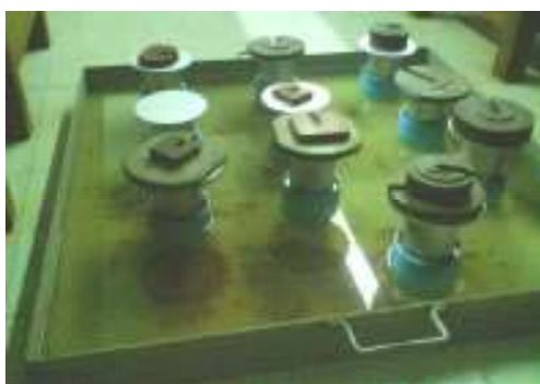
ภาพประกอบที่ 4.1 ดินเหนียวกรุงเทพที่นำมาปั้นขึ้นรูปที่แรงดันต่างๆ
