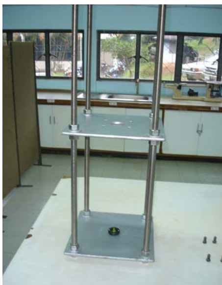
ภาพประกอบที่ ก-1 การหาระดับน้ำของ Farm เครื่องทดสอบ
