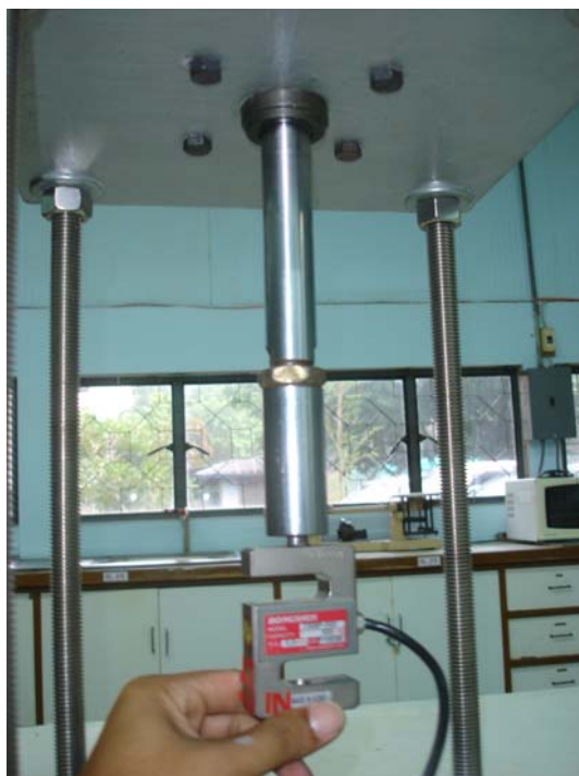
ภาพประกอบที่ ก-4 แสดงการต่อ Load cell เข้ากับแท่งกลึงสแตนเลส
