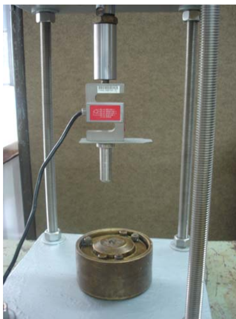
ภาพประกอบที่ ข-10 แสดงการนำ Consolidation cell วางบนเครื่องทดสอบ
