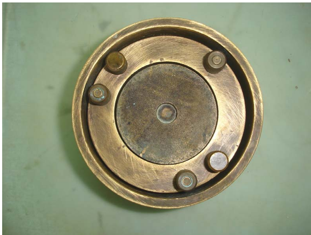
ภาพประกอบที่ ข-6 แสดงการนำ Top Porous Stones วางลงใน Consolidation Cell
