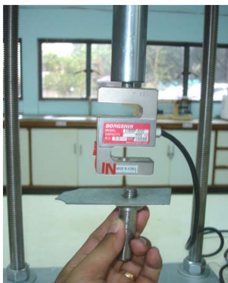
ภาพประกอบที่ ก-5 แสดงการยึดแผ่นสังกะสีกับแท่งสแตนเลสเข้ากับ Load cell
