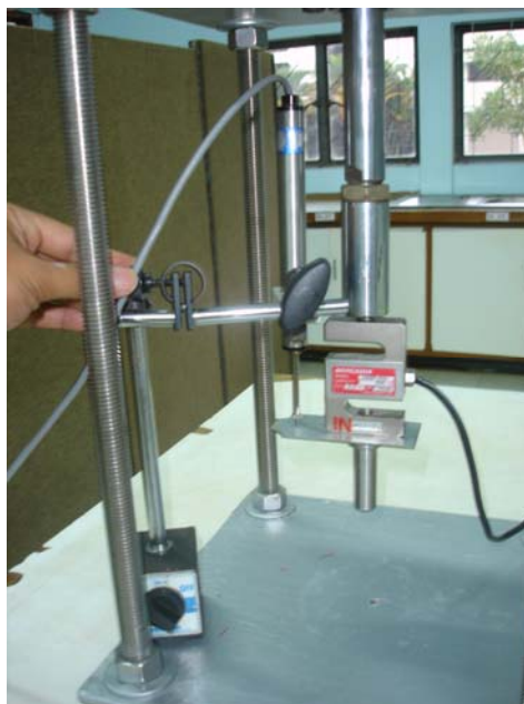
ภาพประกอบที่ ก-6 แสดงการติดตั้ง Displacement Transducer
