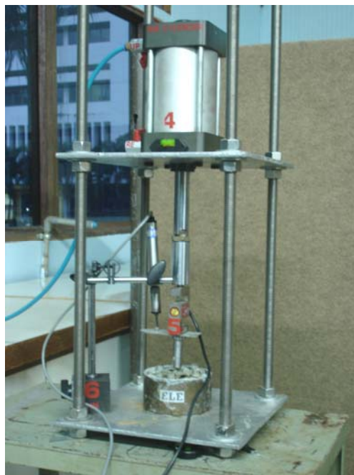
ภาพประกอบที่ ก-14 แสดงภาพอุปกรณ์พร้อมตัวอย่างดิน
