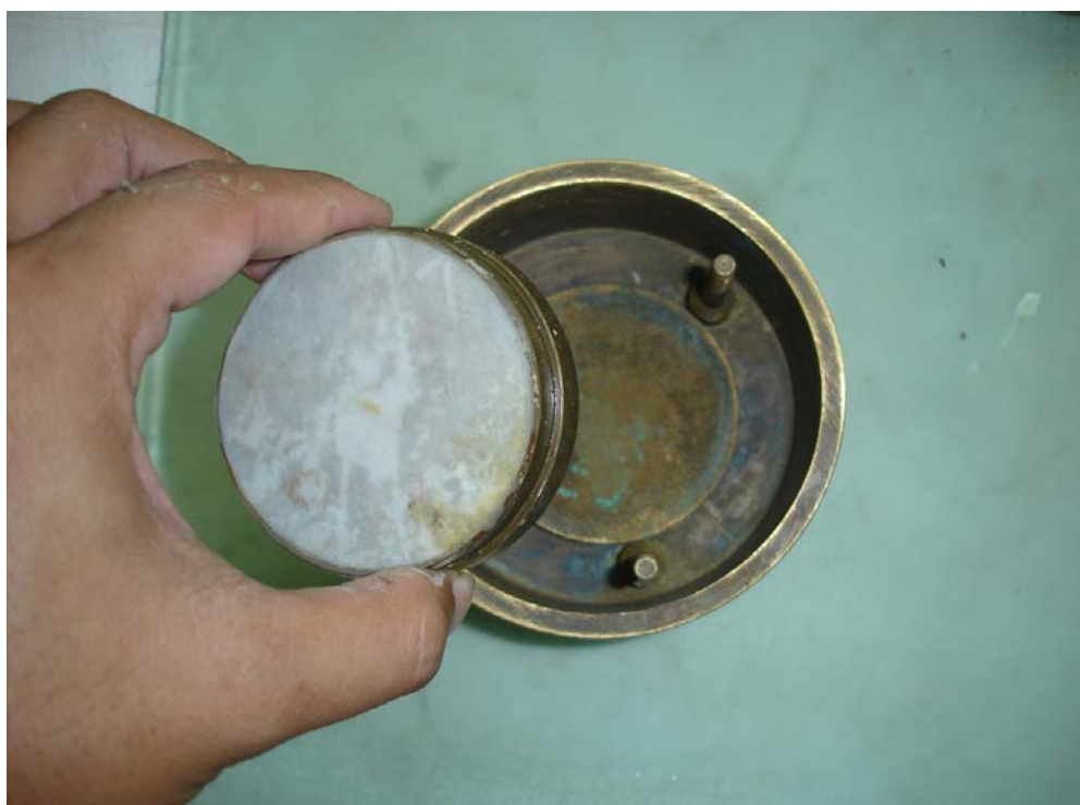
ภาพประกอบที่ ข-5 แสดงการนำตัวอย่างดินวางลงใน Consolidation Cell
