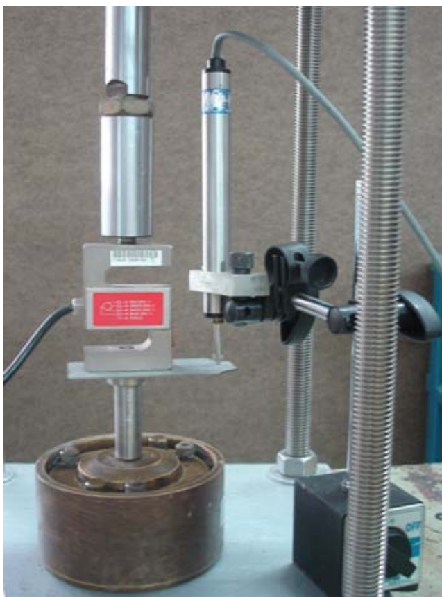
ภาพประกอบที่ ข-14 แสดงการติดตั้ง Displacement Transducer พร้อมแท่นยึดแม่เหล็ก
