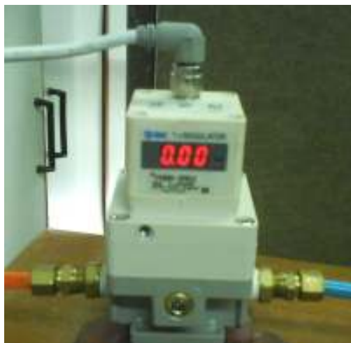
ภาพประกอบที่ 2.6 อุปกรณ์ควบคุมแรงดันแบบนิวแมติกส์ (Electro-pneumatic Regulator)
