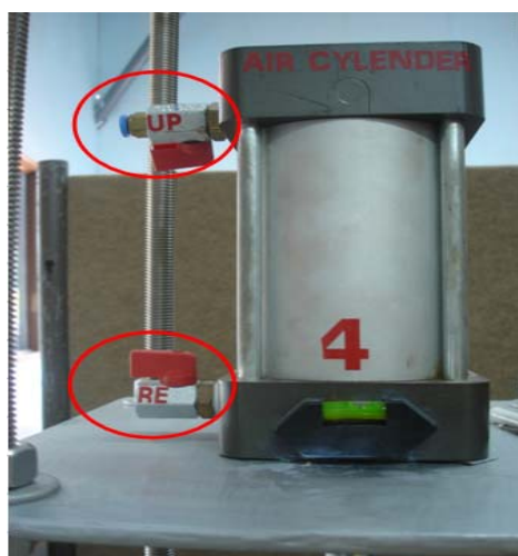
ภาพประกอบที่ ข-11 แสดงการเปิดวาล์วของกระบอกลมทั้งวาล์วบน (UP) และล่าง (RE)
