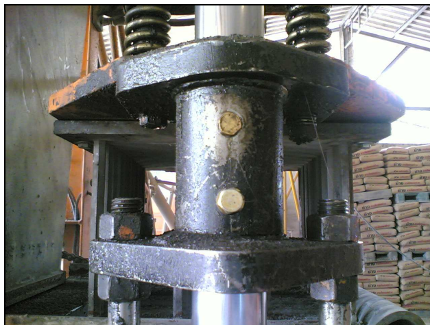
ภาพประกอบ 4.16 รูที่เจาะเพื่อระบายน้ำมันในการทำความสะอาดของตัวประกอบ
