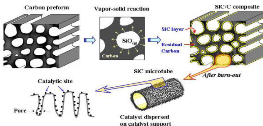
รูปที่ 1.4 ลักษณะภายในรูพรุนของไม้ธรรมชาติหลังจากทำการสังเคราะห์ (ที่มา J.W. Kim และคณะ, 2006)
