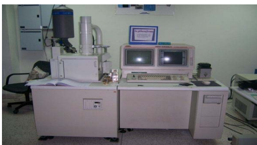
รูปที่ 3.7 กล้องจุลทรรศน์อิเล็กตรอนชนิดส่องกราด
