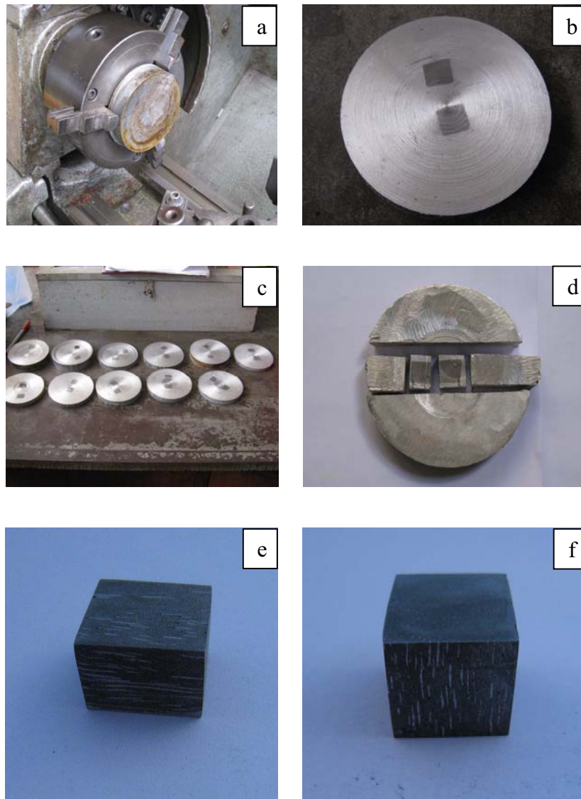
รูปที่ 3.14 แสดงขั้นตอนกระบวนการหล่ออัด SiC/C ด้วยอะลูมิเนียมเหลว A356 (a) แผ่นอะลูมิเนียมที่ได้จากการอัด (b) วัสดุผสม SiC/C พรุนหลังจากปาดหน้าด้วยเครื่องกลึง (c) ลักษณะแผ่นอะลูมิเนียมหลังจากปาดหน้า (d) ชิ้นงานหลังจากการตัด (e) วัสดุผสม SiC/C –Al แนวแกน (f) วัสดุผสม SiC/C –Al แนวรัศมี
