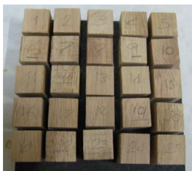
รูปที่ 3.8 ตัวอย่างของชิ้นงานไม้ยางพาราก่อนอบ
