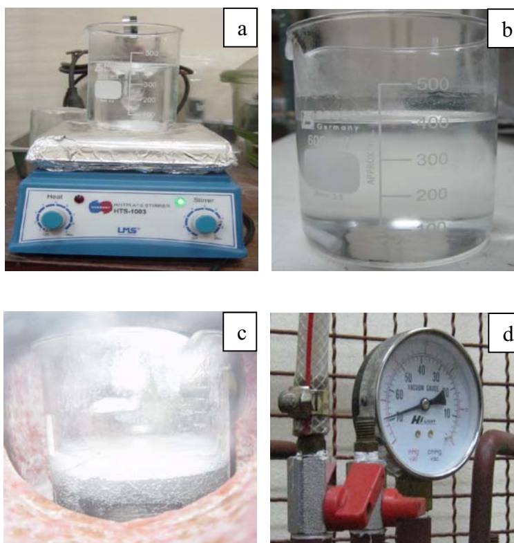
รูปที่ 3.10 กระบวนการ โชลเจด (a) ขณะผสมสารละลายทั้ง 4 ชนิด (b) การตกตะกอนของสารละลาย (c) การแทรกซึมสารละลายเข้าสู่ชิ้นงานคาร์บอน (d) แรงดันสุญญากาศ 70 cmHg ใช้ในการแทรกซึมของสารละลาย
