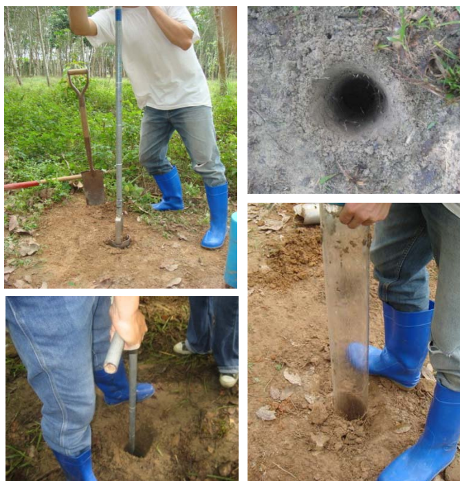
ภาพผนวกที่ 4 การเจาะหลุมเพื่อฝังท่อมินิไรโซทรอนด้วย Hand auger และลักษณะของหลุมที่เจาะ
