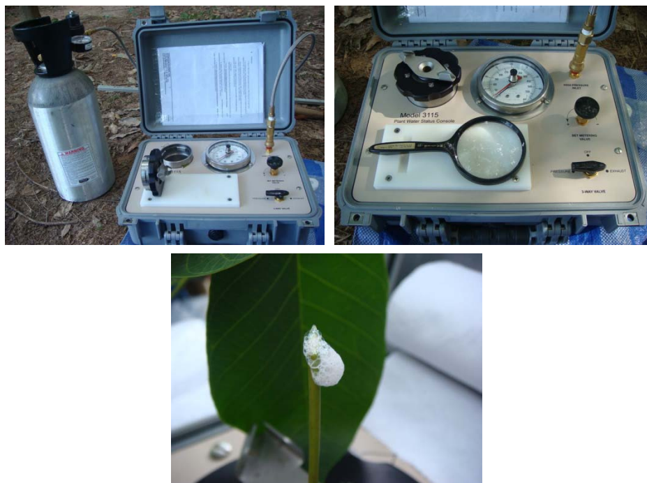
ภาพผนวกที่ 8 การวัดการตอบสนองทางสรีรวิทยาของยางพาราด้วยเครื่องวัดค่าศักย์ของน้ำในใบ
