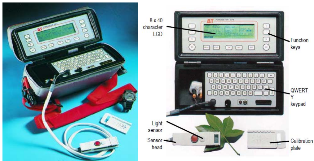
ภาพผนวกที่ 9 การวัดการตอบสนองทางสรีรวิทยาของยางพาราด้วยเครื่องวัดการ ชักน้ำปากใบของยางพารา (Porometer Model AP4)
