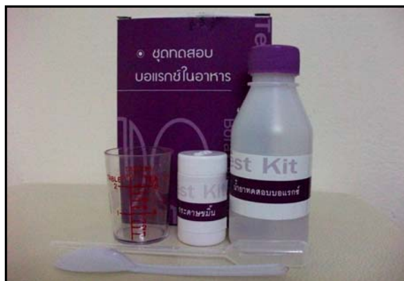
ภาพประกอบภาคผนวก 5 อุปกรณ์ชุดทดสอบบอแรกซ์ในอาหาร
