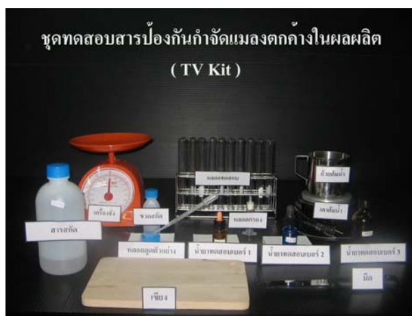
ภาพประกอบภาคผนวก 10 อุปกรณ์ชุดทดสอบสารเคมีป้องกันกำจัดแมลงตกค้างในผลผลิตเกษตร
