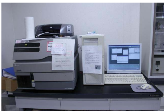
ภาพที่ 4 เครื่องมือที่ใช้วิเคราะห์ระดับพลอยดีของเซลล์พืชเครื่องโพลไซโตมิเตอร์
