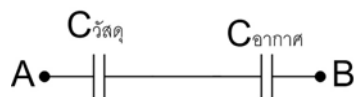
ภาพประกอบ 2-10 วงจรของค่าความจุไฟฟ้าเล็กๆสำหรับแผ่นคู่ขนานแบบกึ่งทรงกระบอก
