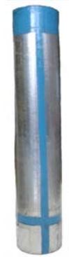
ภาพประกอบ 3-9 เซนเซอร์ความจุไฟฟ้าแบบกึ่งทรงกระบอกมีชุดอิเล็กทรอนิกส์ 2 ชุด ที่ใช้ในการทดลอง
