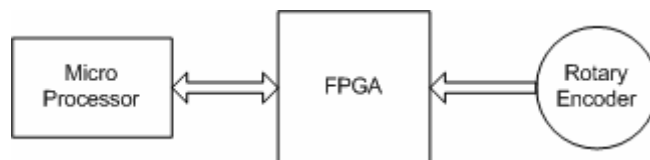
ภาพประกอบ 2-1 แนวคิดของการพัฒนาไอซีเอพฟิเจีต้นแบบ
