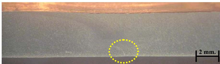
ภาพที่ 4.33 รอยบกพร่องด้วยการตัดแนวเชื่อมที่ As cast + T6 + FSW (1,750/160)
