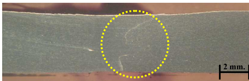
ภาพที่ 4.24 รอยบกพร่องด้วยการตัดแนวเชื่อมที่ As cast + FSW + T6 (1,320/160)
