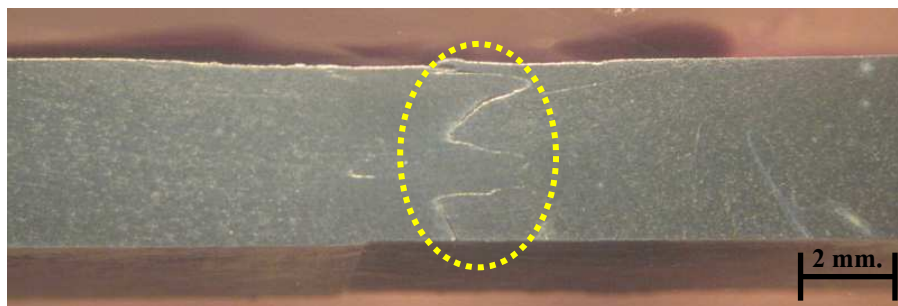
ภาพที่ 4.39 รอยบกพร่องด้วยการตัดแนวเชื่อมที่ As cast + T6 + FSW + T6 (1,750/160)
