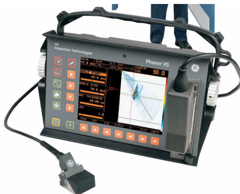
ภาพที่ 2.18 ลักษณะเครื่องอัลตราโซนิกแบบการเรียงเฟส ตรวจสอบงานเชื่อม (An Introduction to Ultrasonic Phased Array Technology, 2552)
