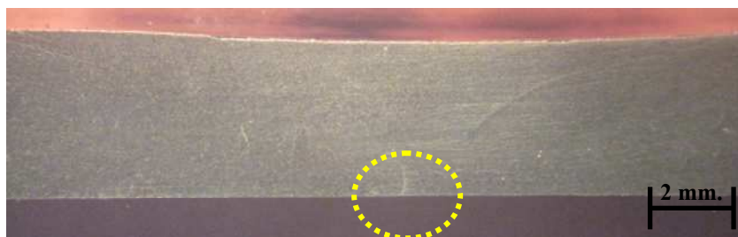
ภาพที่ 4.21 รอยบกพร่องด้วยการตัดแนวเชื่อมที่ As cast + T6 + FSW (1,320/160)
