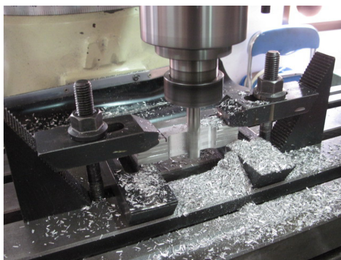
ภาพที่ 3.34 การขึ้นรูปชิ้นทดสอบแรงดึงของเนื้อโลหะเดิม
