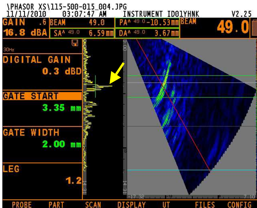
ภาพที่ 4.23 รอยบกพร่องด้วยเครื่องอัลตราโซนิกแบบการเรียงเฟสที่ As cast + FSW + T6 (1,320/160)
