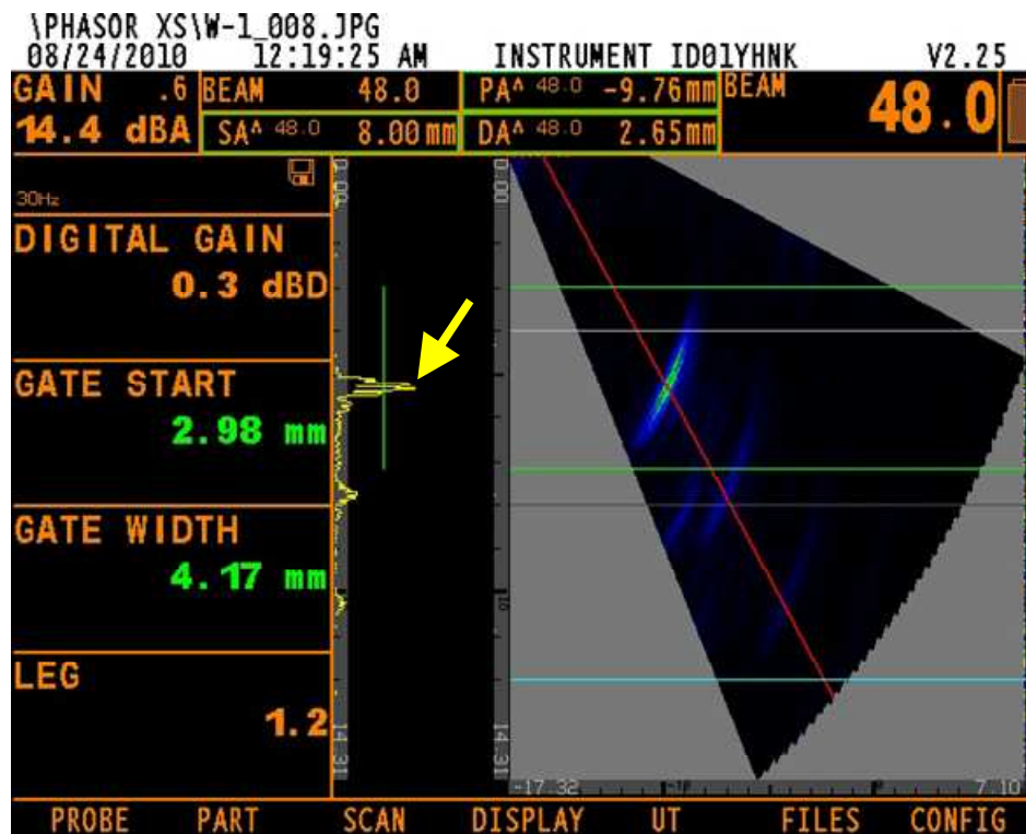
ภาพที่ 4.17 รอยบกพร่องด้วยเครื่องอัลตราโซนิกแบบการเรียงเฟสที่ As cast + FSW (1,320/160)
