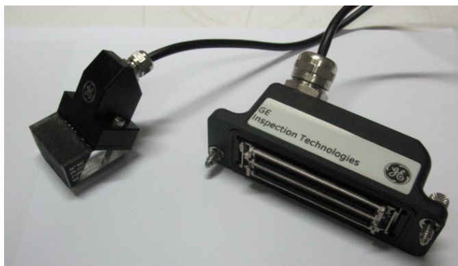
ภาพที่ 3.37 ลักษณะของหัวตรวจสอบ (Wedges) ของเครื่องอัลตราโซนิกแบบการเรียงเฟส
