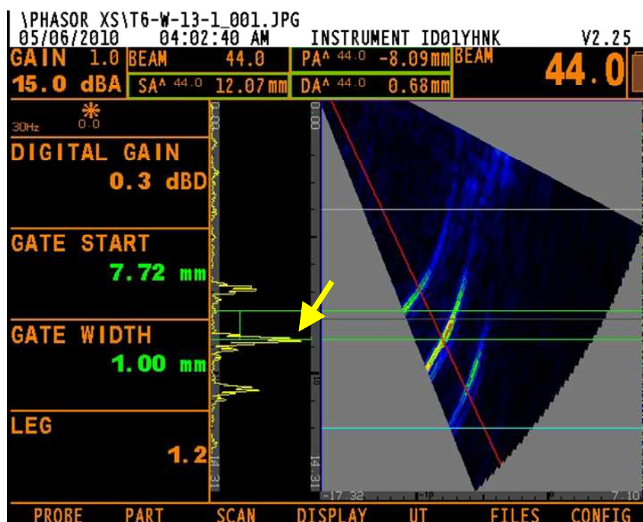
ภาพที่ 4.20 รอยบกพร่องด้วยเครื่องอัลตราโซนิกแบบการเรียงเฟสที่ As cast + T6 + FSW (1,320/160)
