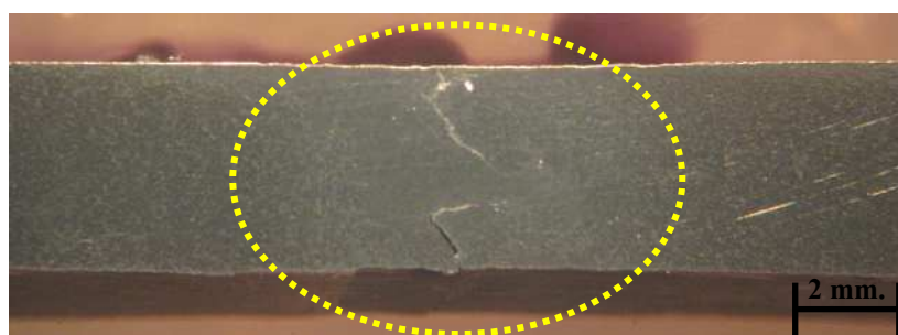
ภาพที่ 4.36 รอยบกพร่องด้วยการตัดแนวเชื่อมที่ As cast + FSW + T6 (1,750/160)
