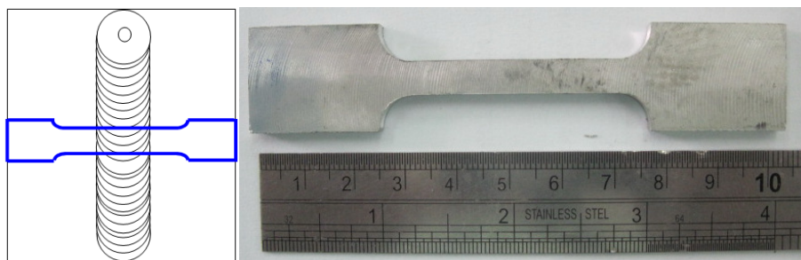
ภาพที่ 3.35 การเตรียมชิ้นทดสอบของรอยเชื่อมเสียดทานแบบกวน
