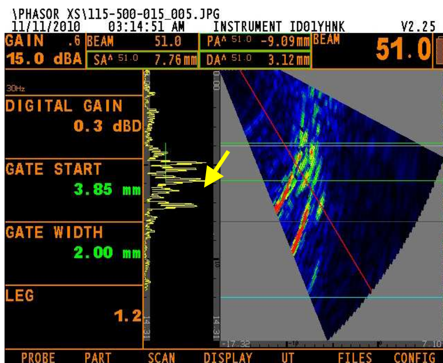
ภาพที่ 4.26 รอยบกพร่องด้วยเครื่องอัลตราโซนิกแบบการเรียงเฟสที่ As cast + T6 + FSW + T6 (1,320/160)
