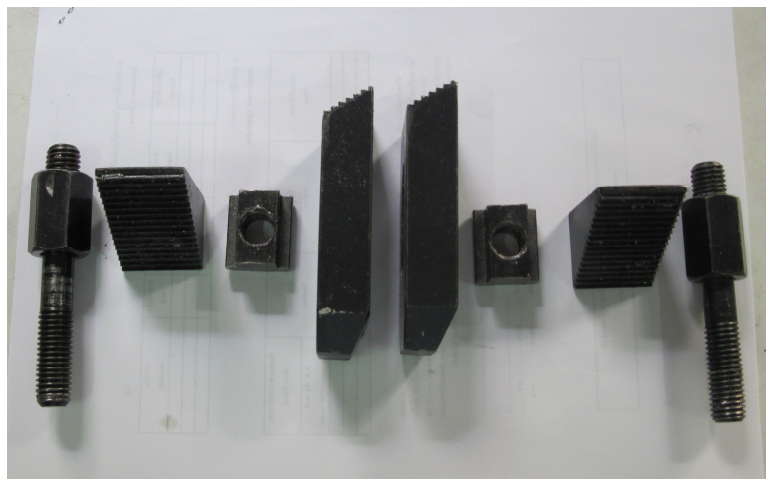
ภาพที่ 3.12 ลักษณะของอุปกรณ์จับยึด (Step Clamp)
