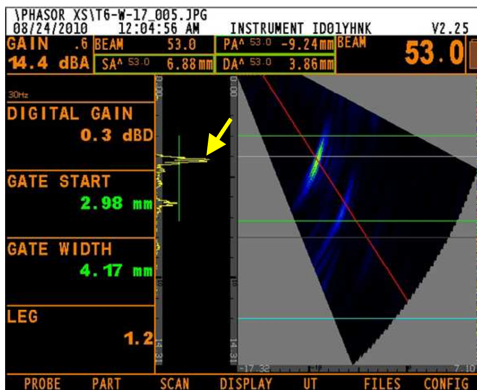
ภาพที่ 4.32 รอยบกพร่องด้วยเครื่องอัลตราโซนิกแบบการเรียงเฟสที่ As cast + T6 + FSW (1,750/160)
