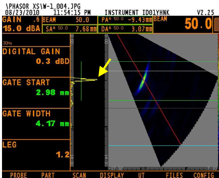
ภาพที่ 4.29 รอยบกพร่องด้วยเครื่องอัลตราโซนิกแบบการเรียงเฟสที่ As cast + FSW (1,750/160)
