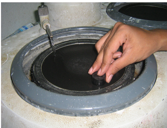
ภาพที่ 3.30 การเตรียมชิ้นงานเพื่อตรวจสอบ โครงสร้างทางโลหะวิทยา
