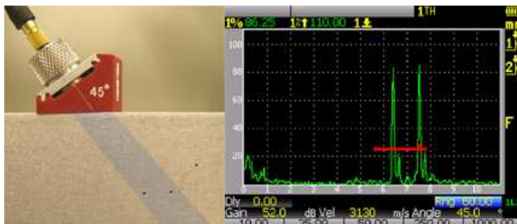
ภาพที่ 2.21 ลักษณะรูปร่างคลื่นเสียง (ซ้าย) ภาพสะท้อนการกวาดภาพคลื่นเสียงทำมุม (ขวา) (An Introduction to Ultrasonic Phased Array Technology, 2552)
