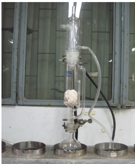
ภาพประกอบที่ ก.1 ชุดอุปกรณ์การสกัดซอกซ์เลต (Soxhlet apparatus)
