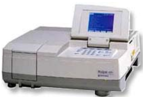
ภาพประกอบที่ ก.5 เครื่อง UV-visible spectrophotometer (SHIMADZU UV-1601)
