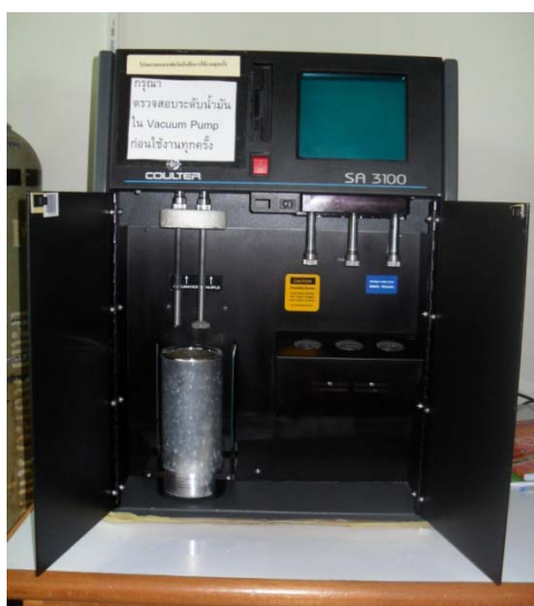
ภาพประกอบที่ ก.2 เครื่อง BET surface area analyzer (SA 3100)
