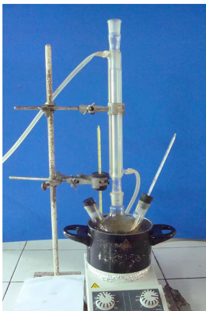
ภาพประกอบที่ 3.4 แสดงชุดการทดลองแบบรีฟลักซ์ในการผลิตเมทิลเอสเทอร์
