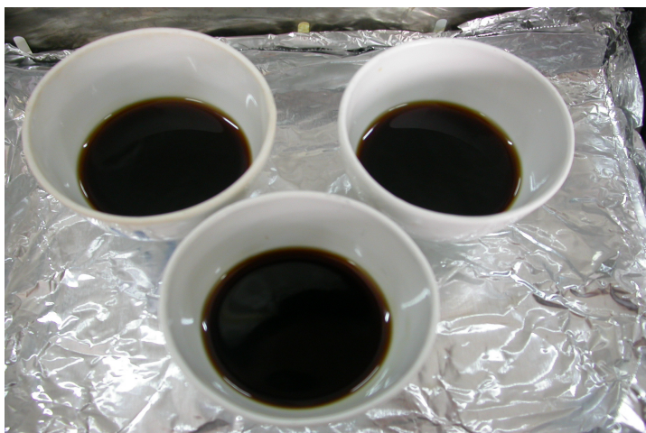
ภาพประกอบที่ ค.3 แสดงลักษณะเมทิลเอสเทอร์ก่อนการเผาที่อุณหภูมิ 775 \pm 25 °C (ASTM D 874)
