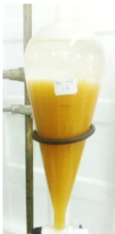
ภาพประกอบที่ 3.3 แสดงขั้นตอนการสกัดสารที่ไม่เกิดสบู่โดยใช้เฮกเซน (Hexane)
