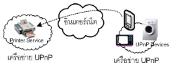
รูปที่ 1 การสื่อสารข้ามเครือข่าย UPnP ผ่านอินเทอร์เน็ต
