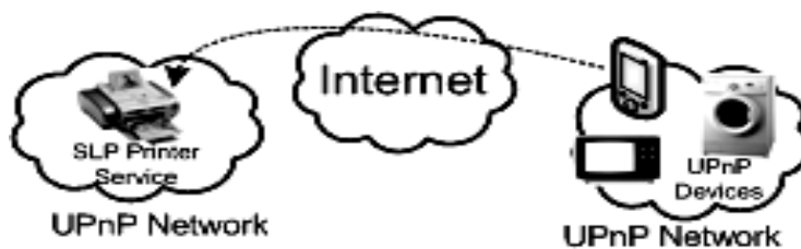
ภาพประกอบ 2-1 การสื่อสารข้ามเครือข่าย UPNP ผ่านอินเทอร์เน็ต
