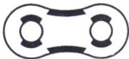
(ก) ตำแหน่งรอยร้าวที่มักเกิดขึ้นบนแผ่นประกบโซ่
