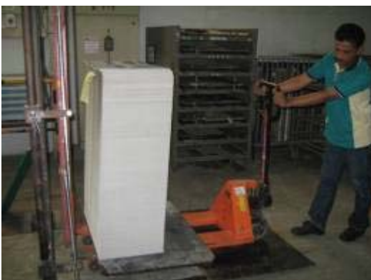
ภาพที่ ก-5 การติดตั้งกระดาษโดยใช้รถ Pallet แทนการติดตั้งแบบเดิม (หลังปรับปรุง)
