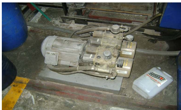
ภาพที่ ง-49 อุปกรณ์อัดอากาศที่ใช้ในโรงงานกรณีศึกษา
