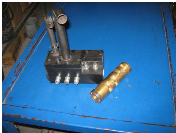
ภาพที่ ง-50 กระบอกลูกสูบแบบโรตารี ที่ใช้ในโรงงานกรณีศึกษา
