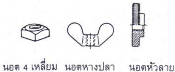
ภาพที่ ง-69 นัต 4 เหลี่ยมและนัตขันด้วยมือเปล่า
