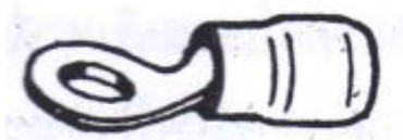
ภาพที่ ง-115 เทอร์มินอลล็ก (Terminal lug)
