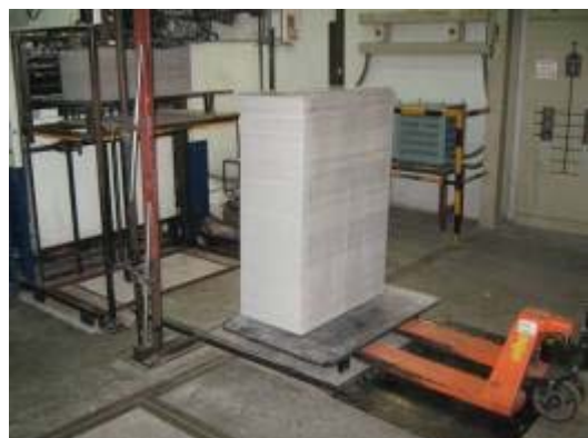
ภาพที่ ก-5 การติดตั้งกระดาษโดยใช้รถ Pallet แทนการติดตั้งแบบเดิม (หลังปรับปรุง)
