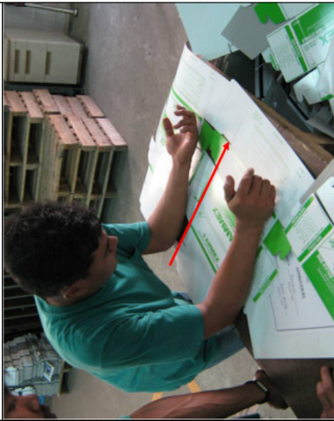
ภาพที่ ค-11 การวิเคราะห์ 5 Why analysis การหยุดจาก Striping mould จะขึ้นงานไม่ตรงแบบของเครื่อง Die-cut
