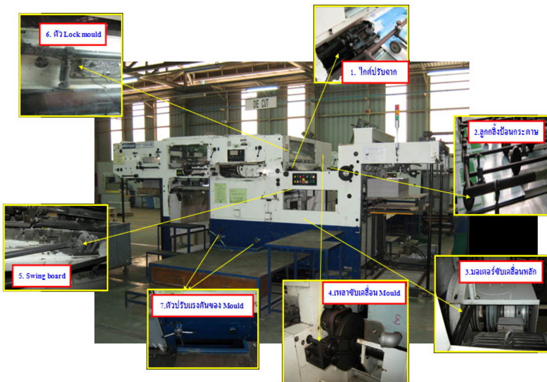
ภาพที่ ข-6 แสดงจุดหล่อลื่นเครื่อง Die-cut
