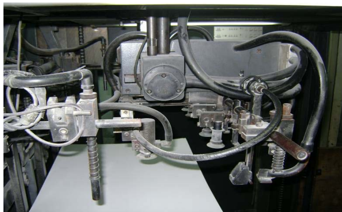
ภาพที่ ง-47 ตัวอย่างอุปกรณ์ดูดจับด้วยสุญญากาศในโรงงานกรณีศึกษา
