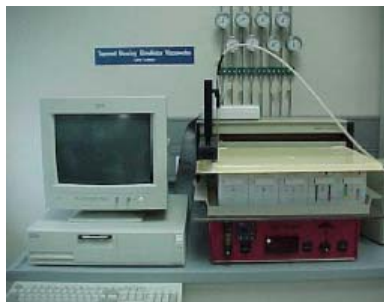
ภาพที่ ค-31 Capillary viscometer ที่ 40องศา ภาพที่ ค-32 Tapere Bearing Simulator ที่ 100 องศา
