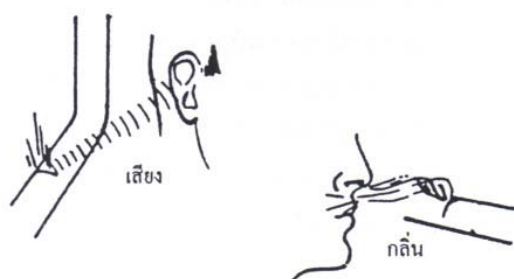
ภาพที่ ง-95 การฟังเสียงและดมกลิ่นการรั่วของสารต่างๆ
