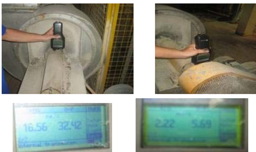
ภาพที่ 5.26 การวินิจฉัยความผิดปกติด้วยเครื่องมือวิเคราะห์การสั่นสะเทือน (ที่มา : อัยฎาฐูร เซาวเหม และอุกฤษฏ์ พาหะพรหม, 2552)
