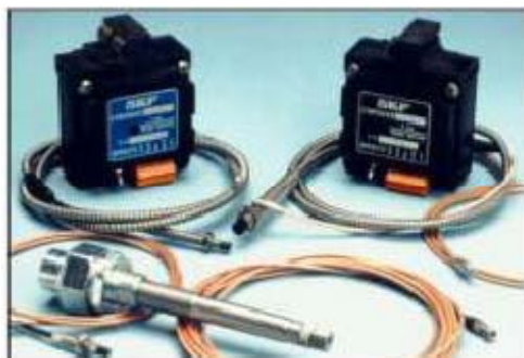
ภาพที่ ค-29 หัววัด Eddy และตัวขับหัววัด Eddy ภาพที่ ค-30 ส่วนปลายของหัววัด Eddy
