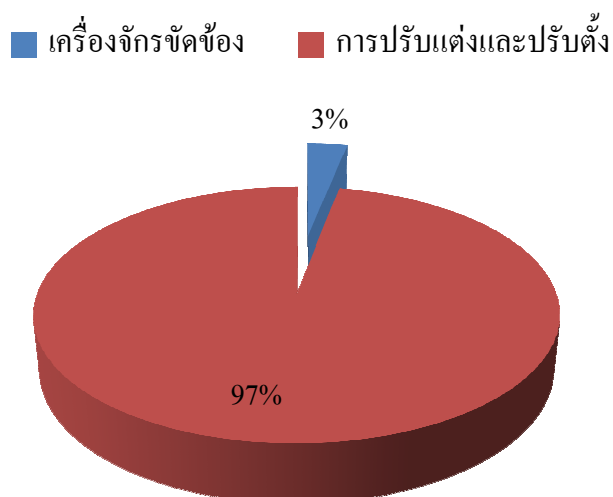
ภาพที่ 3.7 แผนภูมิมวงกลมสาเหตุความสูญเสียที่มีผลต่อค่าความพร้อมในการเดินเครื่อง Off-set printing
