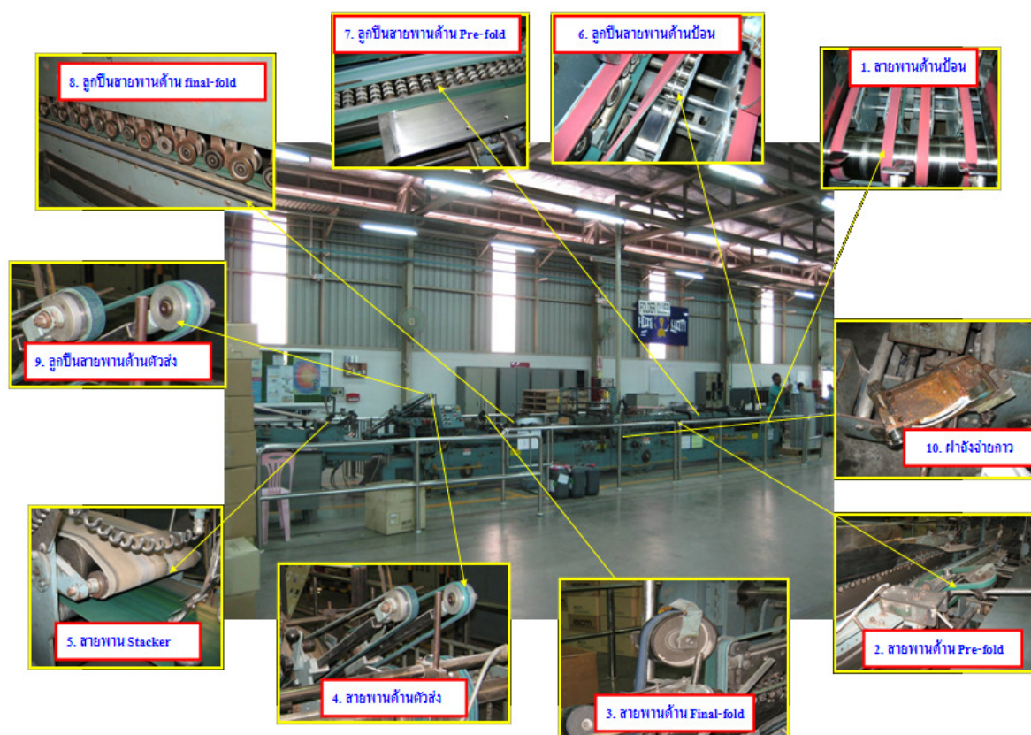
ภาพที่ ข-3 จุดทำความสะอาดเครื่อง Folder-gluer
