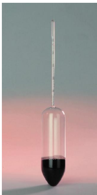
ภาพประกอบที่ 1.1 เมโทรแลค (ที่มา พิมล ผลพฤกษา, 2551)
