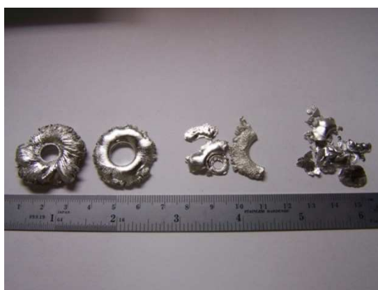
รูปที่ 3.22 ก้อนโลหะดีบุก ที่แข็งตัวบนผนัง ของจานอะตอมไมเซอร์ขนาดแบบ 50 mm ซึ่งถูกเหวี่ยงออกจากจานอะตอมไมเซอร์
