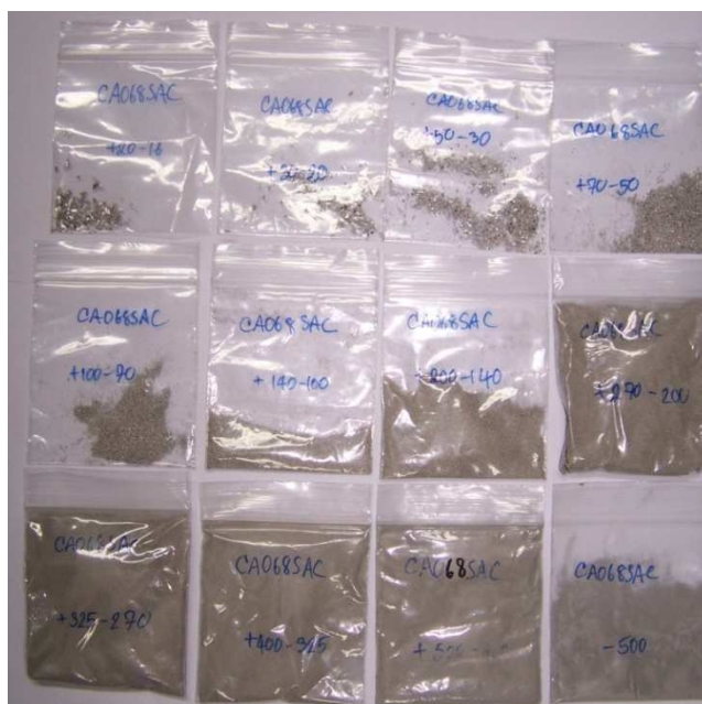
รูปที่ ผข.1 ผงโลหะบัดกรีไร้สารตะกั่วชนิด SAC305 ที่คัดขนาดด้วยชุดตะแกรงมาตรฐาน ASTM E11 แล้ว
