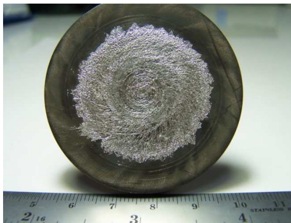
รูปที่ 3.21 ผนัง ของจานอะตอมไมเซอร์ ทรงแบนซึ่งมี ก้อนโลหะดีบุก เกาะ
