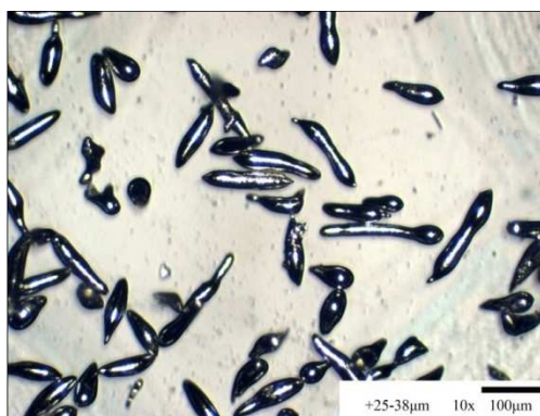
รูปที่ 3.38 ผงโลหะบัดกรีไร้สารตะกั่ว ชนิด SAC305 วงขนาด 38-45µm มีรูป ปทรงแบบหยดน้ำ และลิแกเมนต์ปะปนกัน
