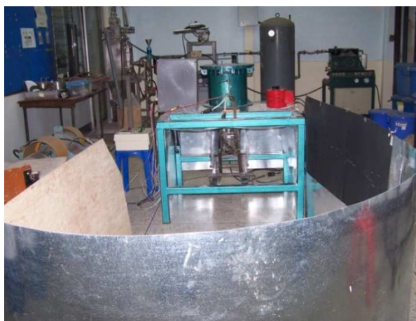
รูปที่ 2.6 ฉากรับผงโลหะที่ติดตั้งที่บริเวณหน้าชุดทดลองผลิตผงโลหะดิบด้วยวิธีอะตอมไมเซชันเบื้องต้น
