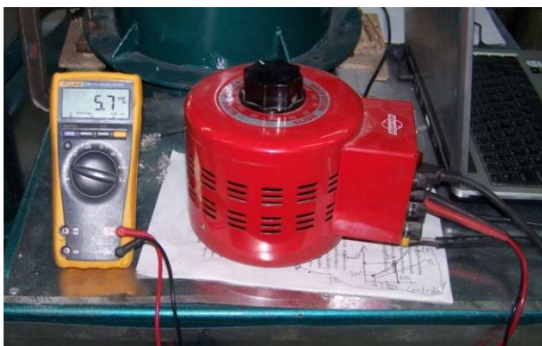
รูปที่ 2.8 อุปกรณ์ปรับแรงดันไฟฟ้าเพื่อควบคุมความเร็วรอบของมอเตอร์
