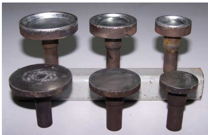
รูปที่ 2.12 จานอะตอมไมเซอร์ทรงแบน (แถวหน้า) และทรงถ้วย (แถวหลัง) ขนาด 30, 40 และ 50 mm (จากขวาไปซ้าย) ทั้งหมดผ่านการเคลือบผิวหน้าด้วยโลหะบัดกรีชนิด SAC305
