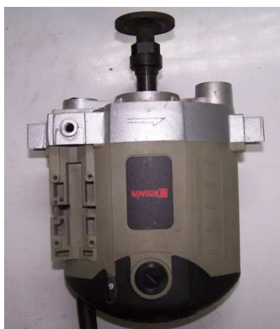
รูปที่ 2.7 มอเตอร์ความเร็วสูงติดตั้งงานอะตอมไมเซอร์ทรงเบน
