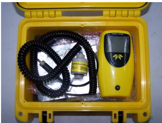
รูปที่ 2.14 อุปกรณ์ตรวจรู้ปริมาณออกซิเจนพร้อมมิเตอร์แสดงผล
