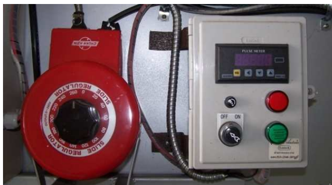
รูปที่ 2.13 อุปกรณ์ปรับแรงดันไฟฟ้าขาเข้ามอเตอร์ (ซ้าย) และอุปกรณ์แสดงค่าความเร็วรอบของมอเตอร์ (ขวา)
