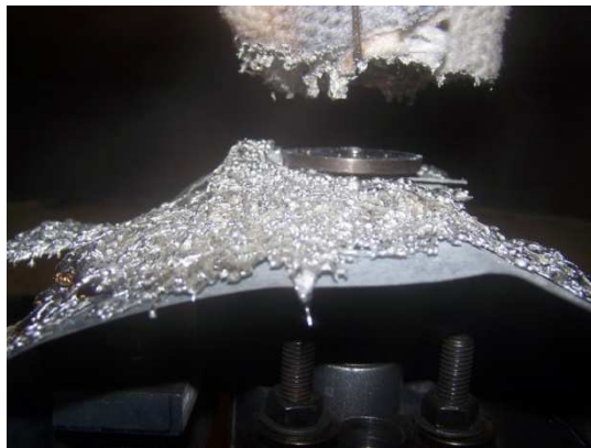
รูปที่ 3.5ก้อนโลหะที่ ' อยู่ ' รอบๆ งานอะตอมไมเซอร์ เนื่องจากไม่สะอาดการ ไมเซอร์ น
