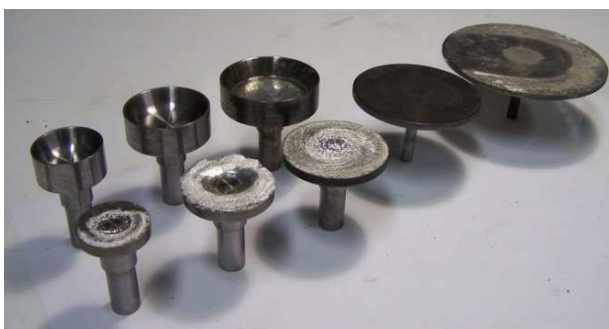
รูปที่ 2.9 จานอะตอมไมเซอร์ทรงแบน (แถวหน้า) และทรงถ้วย (แถวหลัง) ขนาด 30, 40, 50, 70 และ 100 mm (จากซ้ายไปขวา)
