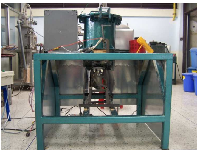
รูปที่ 2.4 ชุดทดลองผลิตผงโลหะด้วยวิธีอะตอมไมเซอร์โดยอาศัยหลักการหมุนเหวี่ยงเบื้องต้น
