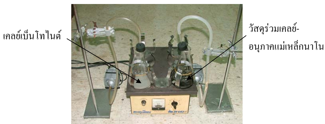
ภาพประกอบ 2.15 ชุดให้ออกซิเจนและเครื่องเขย่า
