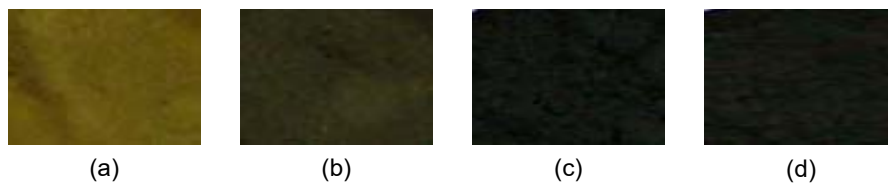
ภาพประกอบ 3.3 ลักษณะสีของอนุภาคเหล็กออกไซด์สังเคราะห์โดยวิธี D ที่อุณหภูมิติดตะกอน (a) 25°C, (b) 50°C, (c) 70°C และ (d) 90°C
