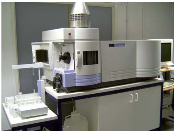
ภาพประกอบ 2.16 เครื่องพลาสมาเหนี่ยวนำคู่ควม-สเปกโตรสโกปีแบบเปล่งแสง
