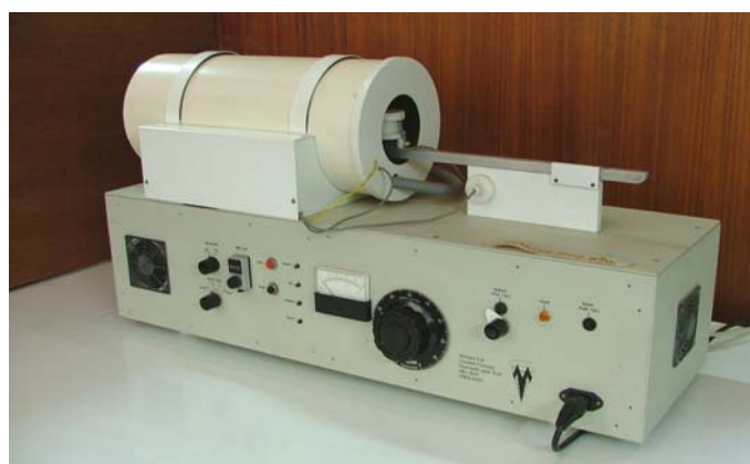
ภาพประกอบ 2.11 เครื่องลบล้างอำนาจแม่เหล็กตกค้างชนิด IRM โดยใช้สนามแม่เหล็กสลับ
