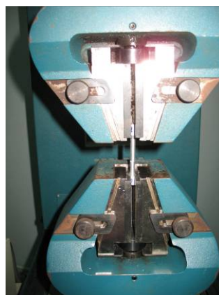
รูปที่ 3.28 ลักษณะของชิ้นงานที่ถูกดึงโดยเครื่อง UTM
