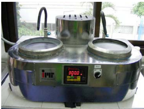
รูปที่ 2.13 เครื่องขัดชิ้นงานแบบขัดหยาบและขัดละเอียด
