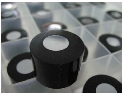
รูปที่ 2.12 ชิ้นงานที่ผ่านการขึ้นรูปแบบร้อน (Hot Mounting)
