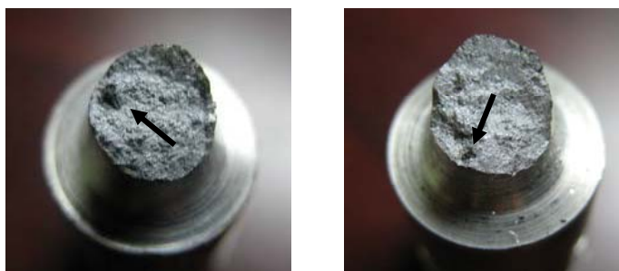
รูปที่ 3.30 ออกไซด์ฟิล์มภายในเนื้อชิ้นงาน
