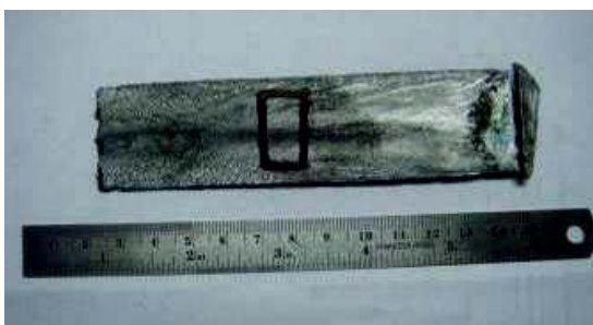
รูปที่ 3.2 ชิ้นงานจากแม่พิมพ์ทองแดงและบริเวณตรงกลางสำหรับนำไปวิเคราะห์โครงสร้างจุลภาค
