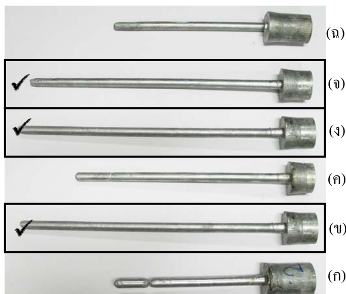
รูปที่ 3.19 การเปรียบเทียบชิ้นงานชิ้นงานที่ได้จากการอัดรีดที่เงื่อนไขการอัดรีดต่าง ๆ โดย (ก) ความเร็วในการอัดรีดเท่ากับ 2 สัดส่วนของแข็งเท่ากับ 5% (ข) ความเร็วในการอัดรีดเท่ากับ 4 สัดส่วนของแข็งเท่ากับ 5% (ค) ความเร็วในการอัดรีดเท่ากับ 4 สัดส่วนของแข็งเท่ากับ 10% (ง) ความเร็วในการอัดรีดเท่ากับ 6 สัดส่วนของแข็งเท่ากับ 5% (จ) ความเร็วในการอัดรีดเท่ากับ 6 สัดส่วนของแข็งเท่ากับ 10% และ (ฉ) ความเร็วในการอัดรีดเท่ากับ 6 สัดส่วนของแข็งเท่ากับ 15%
