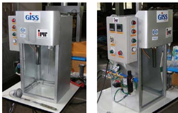
รูปที่ 2.4 เครื่องผลิตโลหะกึ่งของแข็งด้วยการพ่นฟองแก๊สขณะแข็งตัวเวอร์ชัน 1
