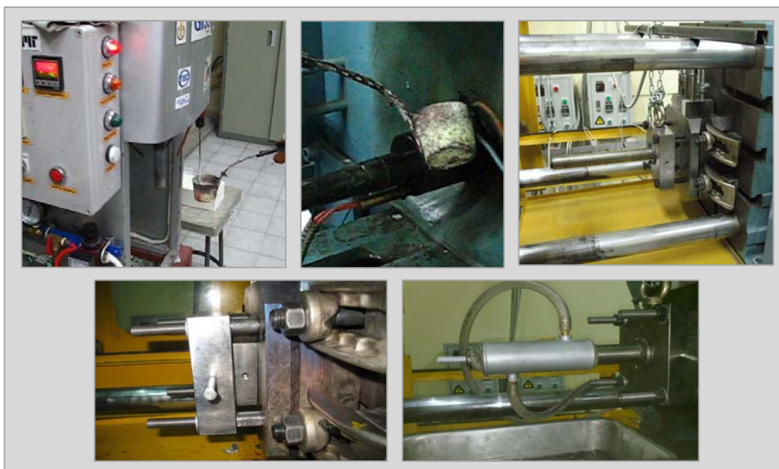
รูปที่ 2.10 ตัวอย่างขั้นตอนในการอัดรีดอะลูมิเนียมกึ่งของแข็งด้วยเครื่องฉีดโลหะ
