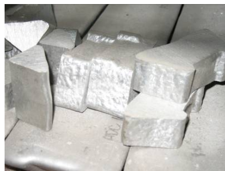
รูปที่ 2.1 อินกอทอะลูมิเนียมผสมเกรด 356 ที่ใช้ในงานวิจัย
