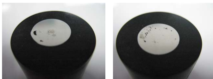
รูปที่ 3.12 โพรงหดตัวระดับมหภาคและรูเก็สที่เกิดขึ้นภายในเนื้อของชิ้นงานหลังจากทำการขัดหยาบด้วยกระดาษทรายน้ำ
