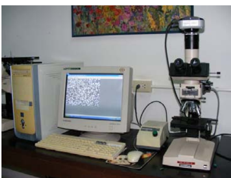
รูปที่ 2.14 กล้องจุลทรรศน์แบบใช้แสง (Optical Microscope)
