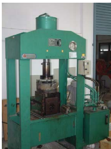
รูปที่ 2.5 เครื่องอัดไฮดรอลิกแนวตั้งและแวนอนที่ใช้ในการศึกษาความเป็นไปได้เบื้องต้น
