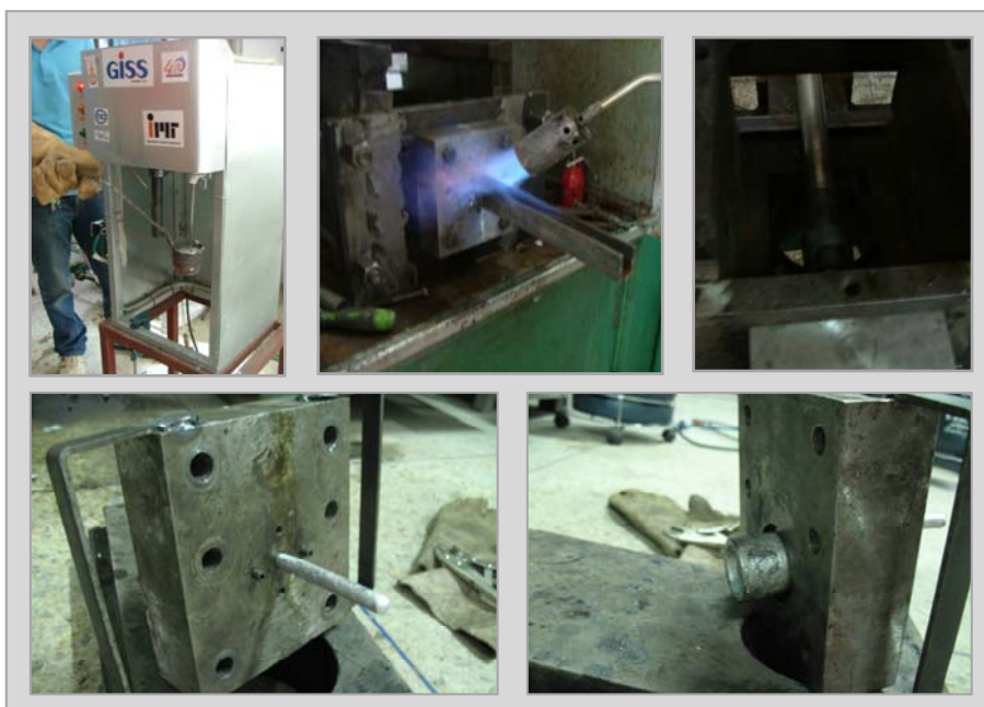
รูปที่ 2.9 ตัวอย่างขั้นตอนในการอัดรีดอะลูมิเนียมกึ่งของแข็งเบื้องต้น
