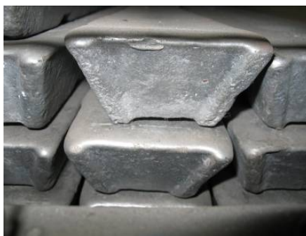
รูปที่ 2.1 อินกอทอะลูมิเนียมผสมเกรด 356 ที่ใช้ในงานวิจัย
