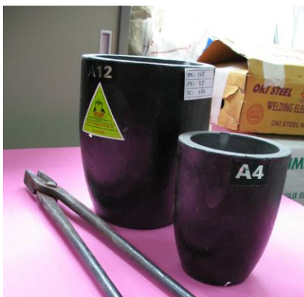
รูปที่ 2.3 ตัวอย่างเบ้าหลอมกราไฟต์ ที่ใช้ในการทดลอง
