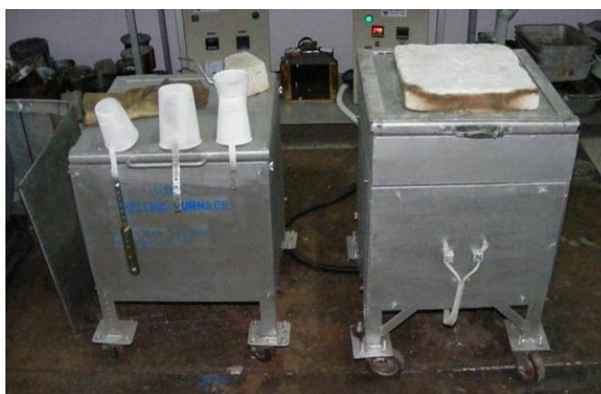
รูปที่ 2.2 เตาหลอมไฟฟ้าชนิดลวดความต้านทานที่ใช้ในการทดลอง
