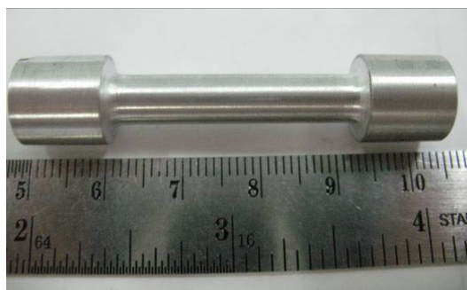
รูปที่ 3.27 ชิ้นงานที่ใช้ในการทดสอบความแข็งแรงดึงสูงสุด
