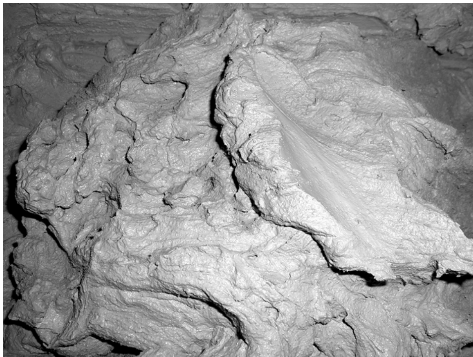
รูปที่ 3.8 ตัวอย่างดินผสมที่ปริมาณน้ำมากกว่าพิกัดเหลวที่ใช้สร้างตัวอย่าง
