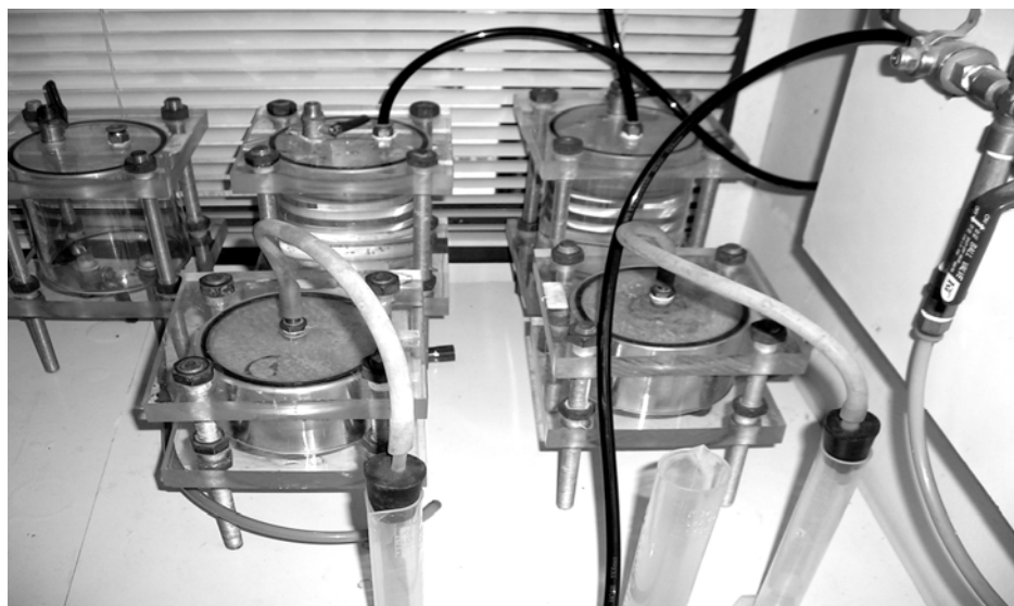
รูปที่ 3.11 เครื่องมือทดสอบค่าสัมประสิทธิ์การซึมผ่านแบบความดันคงที่โดยใช้ความดันอากาศเป็นตัวควบคุมความดัน
