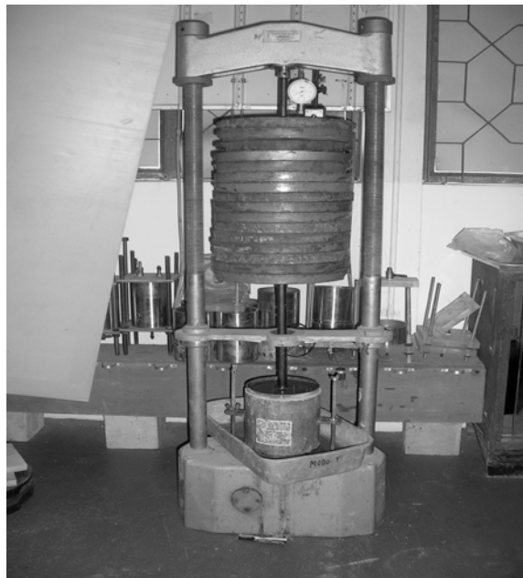
รูปที่ 3.6 การ Consolidate ตัวอย่าง โดยเครื่องมือที่สร้างขึ้นเพื่อให้ดินตัวอย่างสามารถขึ้นรูปได้
