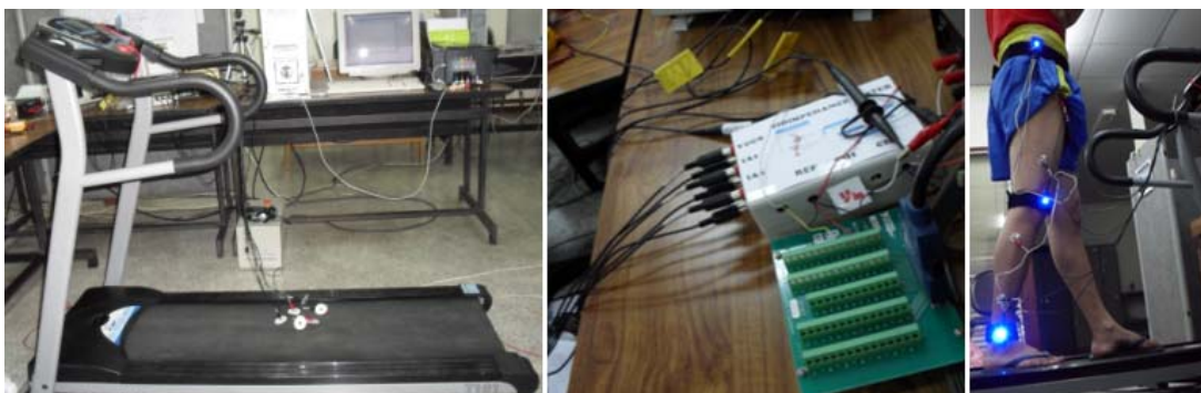
ภาพประกอบ 4-2 การติดตั้งอุปกรณ์สำหรับการตรวจวัดไบโออิมพีแดนซ์สำหรับการตรวจวัดจริง
