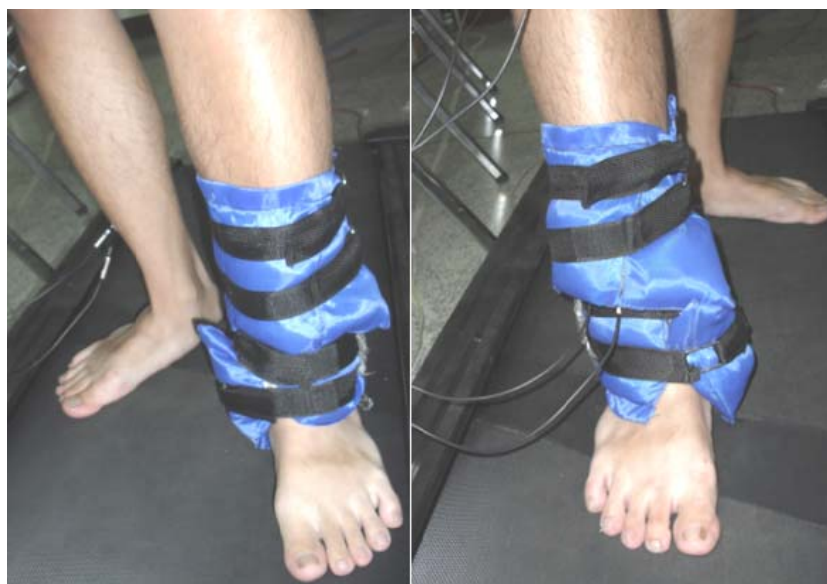
ภาพประกอบ 4-11 การติดตั้งตุ้มน้ำหนักสำหรับสร้างภาระในการเดิน
