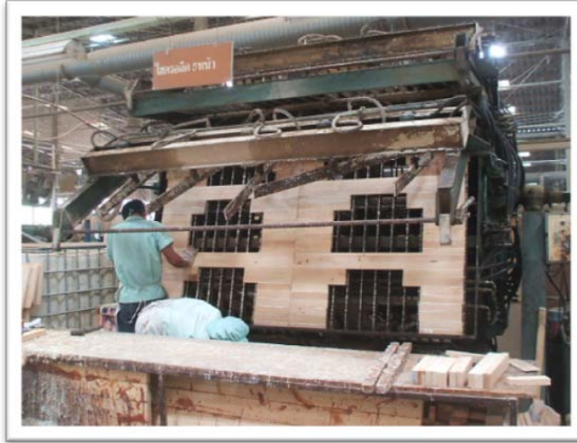
รูปที่ 3.4 การเปลาะไม้
