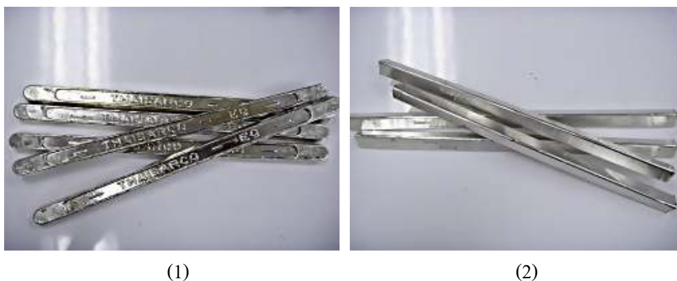
รูปที่ 2.17 วัตถุดิบที่ใช้ในการทดลอง 1) แท่งดิบ และ 2) แท่งโลหะบัดกรี SAC 305
