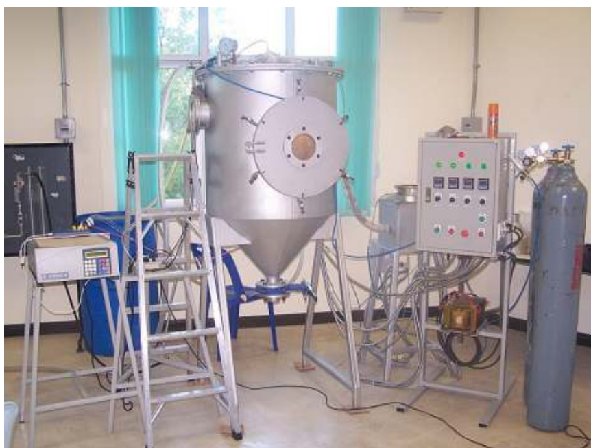
รูปที่ 2.16 เครื่องอัลตราโซนิกอะตอมไมเซชันที่ได้จัดทำขึ้น
