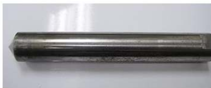
รูปที่ 2.10 ขนาดและลักษณะของอัลตราโซนิกโพรบที่ได้จัดทำขึ้น
