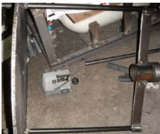
รูปที่ 2.12 ตัวจับยึดเครื่องอัลตราโซนิกภายในถังอะตอมไมเซอร์ที่ได้จัดทำขึ้น
