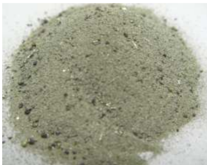
รูปที่ 2.19 ผงโลหะที่ผลิตได้จากกระบวนการอัลตราโซนิกอะตอมไมเซชัน
