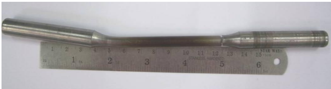
รูปที่ 9 ชิ้นทดสอบความแข็งแรงล้าจากเนื้อเชื่อม MAG ทดสอบที่ 500 MPa ชั้นที่ 1
