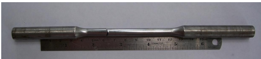
รูปที่ 11 ชิ้นทดสอบความแข็งแรงล้าจากเนื้อเชื่อม MMA ทดสอบที่ 600 MPa ชั้นที่ 1
