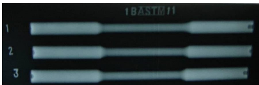
รูปที่ 3.14 फिल्मถ่ายภาพขั้นตอนทดสอบความแข็งแรงล้าจากเนื้อเชื่อม MAG ชั้นที่ 1-3
