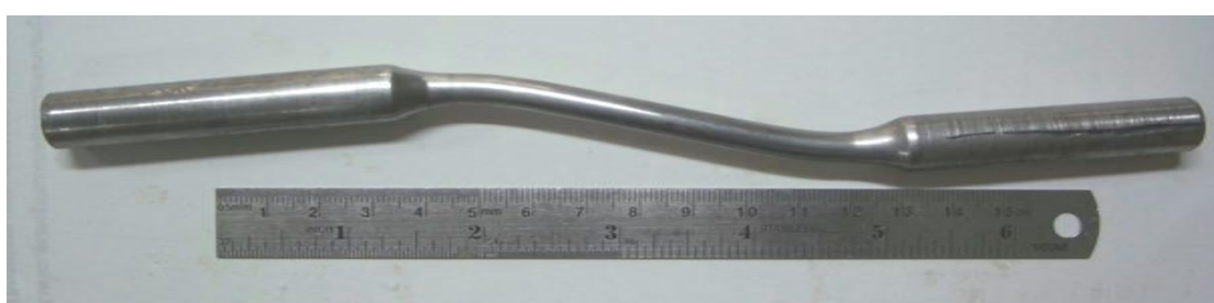
รูปที่ ง18 ชิ้นทดสอบความแข็งแรงล้าจากเนื้อเชื่อม MAG ทดสอบที่ 700 MPa ชั้นที่ 1
