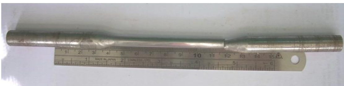
รูปที่ 16 ชิ้นทดสอบความแข็งแรงดึงเหล็กกล้าผสมต่ำ AISI 4340 ทดสอบที่ 600 MPa ชั้นที่ 2
