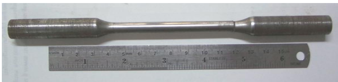
รูปที่ ง20 ชิ้นทดสอบความแข็งแรงล้าเหล็กกล้าผสมคาร์บอน AISI 4340 ทดสอบที่ 700 MPa ชั้นที่ 1
