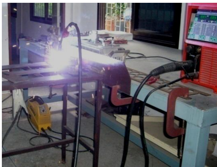
รูปที่ 2.11 กรรมวิธีการเชื่อมมิก/แมก และกรรมวิธีการเชื่อมไส้ฟลักซ์ซึ่งเป็นการเชื่อม แบบกึ่งอัตโนมัติ
