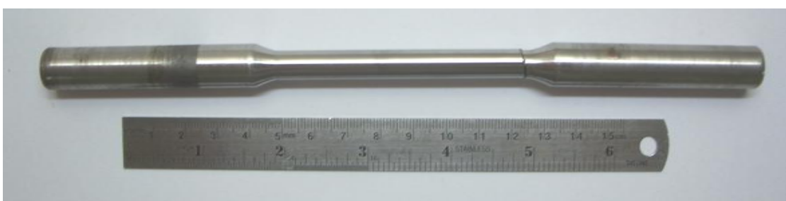
รูปที่ ๖6 ชิ้นทดสอบความแข็งแรงล้าจากเนื้อเชื่อม FCAW ทดสอบที่ 400 MPa ชั้นที่ 1
