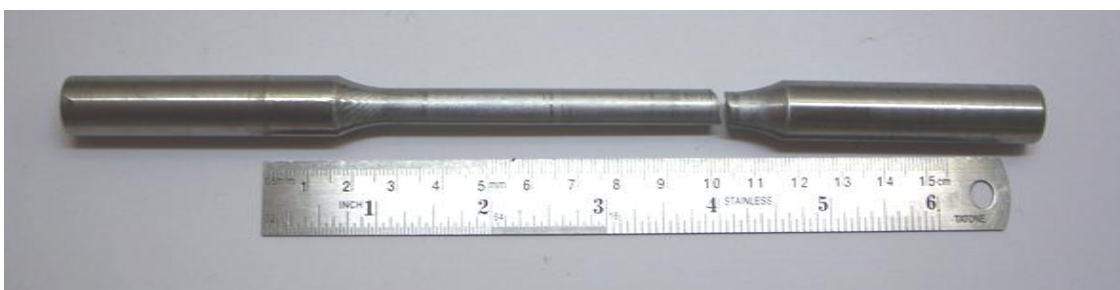
รูปที่ ๖8 ชิ้นทดสอบความแข็งแรงล้าเหล็กกล้าผสมต่ำ AISI 4340 ทดสอบที่ 400 MPa ชั้นที่ 2
