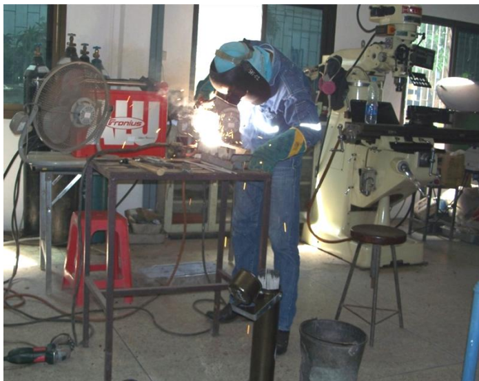
รูปที่ 2.10 กรรมวิธีการเชื่อมไฟฟ้าด้วยลวดเชื่อมหุ้มฟลักซ์
