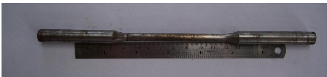
รูปที่ 12 ชิ้นทดสอบความแข็งแรงล้าจากเนื้อเชื่อม MMA ทดสอบที่ 600 MPa ชั้นที่ 2
