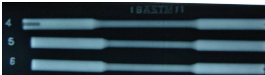
รูปที่ 3.13 फिल्मถ่ายภาพขั้นตอนทดสอบความแข็งแรงล้าจากเนื้อเชื่อม MMA ชั้นที่ 4-6
