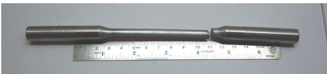
รูปที่ 3 ชิ้นทดสอบความแข็งแรงล้าจากเนื้อเชื่อม MAG ทดสอบที่ 400 MPa ชั้นที่ 1
