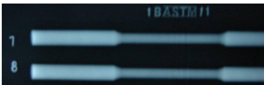
รูปที่ 3.19 फिल्मถ่ายภาพชั้นทดสอบความแข็งแรงล้าจากเนื้อเชื่อม FCAW ชั้นที่ 7-8
