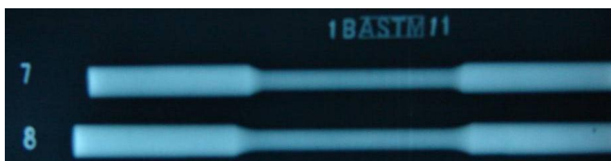
รูปที่ 3.16 फिल्मถ่ายภาพขั้นตอนทดสอบความแข็งแรงล้าจากเนื้อเชื่อม MAG ชั้นที่ 7-8
