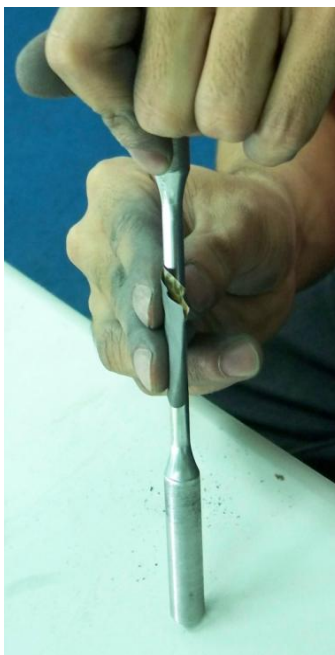
รูปที่ 2.17 การขัดชิ้นทดสอบก่อนทดสอบความแข็งแรงล้า
