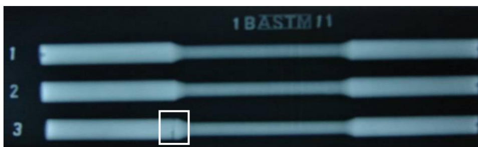
รูปที่ 3.12 फिल्मถ่ายภาพขึ้นทดสอบความแข็งแรงถ้าจากเนื้อเชื่อม MMA ชั้นที่ 1-3
