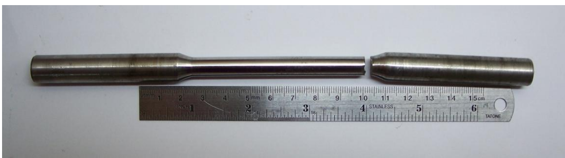
รูปที่ 10 ชิ้นทดสอบความแข็งแรงล้าจากเนื้อเชื่อม FCAW ทดสอบที่ 500 MPa ชั้นที่ 1
