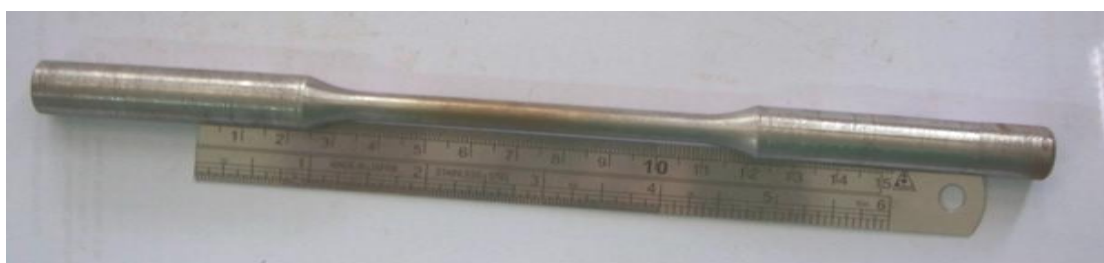
รูปที่ ง19 ชิ้นทดสอบความแข็งแรงล้าจากเนื้อเชื่อม FCAW ทดสอบที่ 700 MPa ชั้นที่ 1
