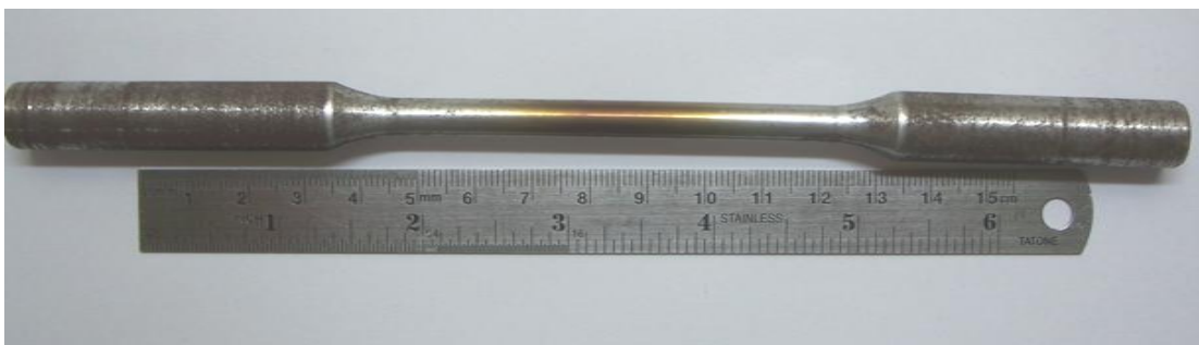
รูปที่ ง22 ชิ้นทดสอบความแข็งแรงล้าเหล็กกล้าผสมต่ำ AISI 4340 ทดสอบที่ 800 MPa
