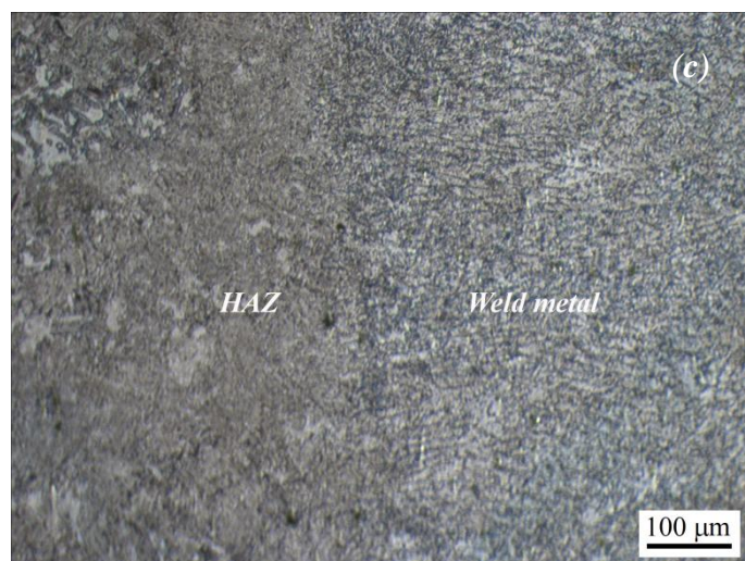
รูปที่ 3.2 โครงสร้างจุลภาคบริเวณเส้นหลอมละลาย (a) MMA (b) MAG (c) FCAW
