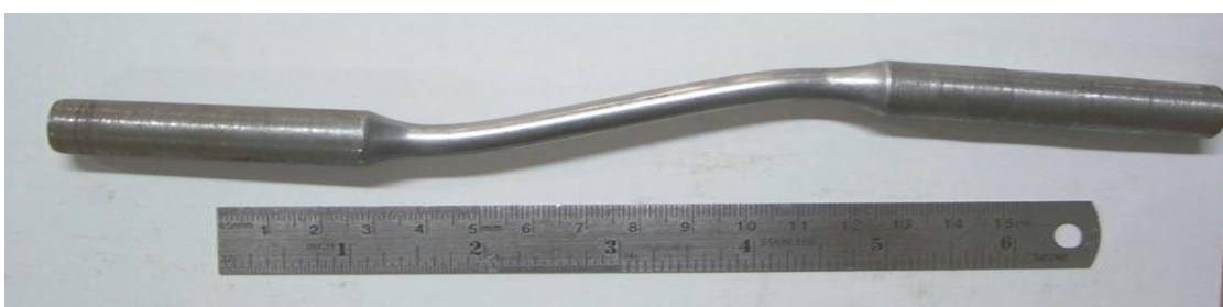
รูปที่ 14 ชิ้นทดสอบความแข็งแรงดึงจากเนื้อเชื่อม MAG ทดสอบที่ 600 MPa ชั้นที่ 2
