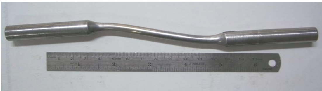
รูปที่ ง21 ชิ้นทดสอบความแข็งแรงล้าจากเนื้อเชื่อม FCAW ทดสอบที่ 800 MPa
