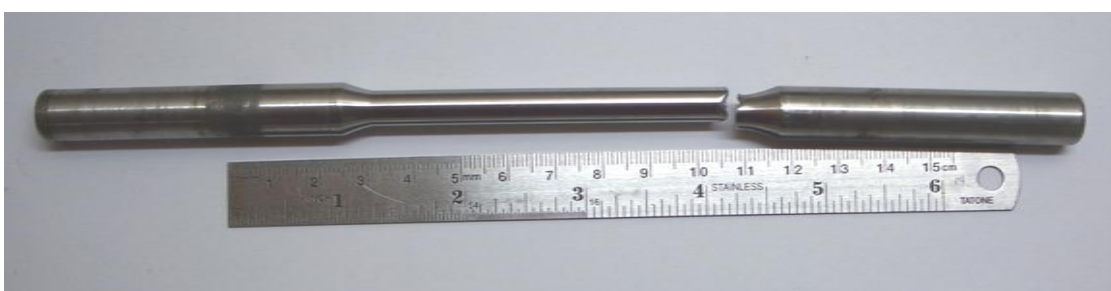
รูปที่ 2 ชิ้นทดสอบความแข็งแรงล้าจากเนื้อเชื่อม MMA ทดสอบที่ 400 MPa
