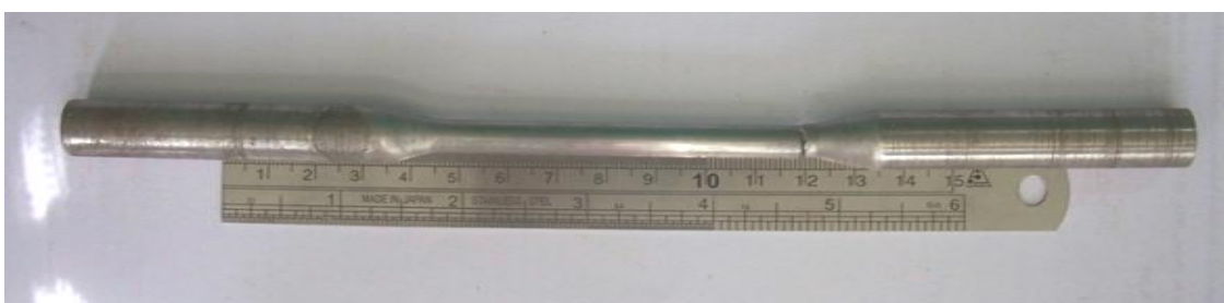
รูปที่ ๖7 ชิ้นทดสอบความแข็งแรงล้าเหล็กกล้าผสมต่ำ AISI 4340 ทดสอบที่ 400 MPa ชั้นที่ 1
