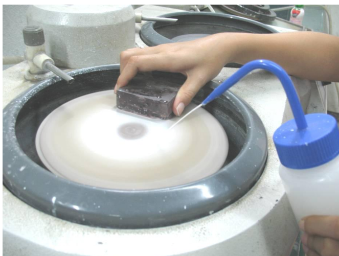
รูปที่ 2.19 การขัดชิ้นงานด้วยผงอลูมินา
