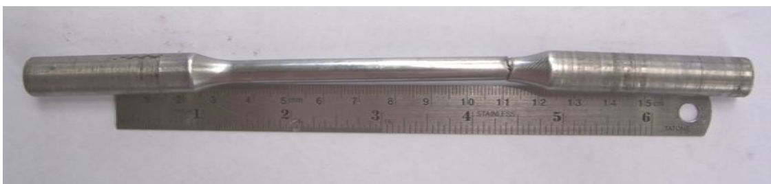
รูปที่ 4 ชิ้นทดสอบความแข็งแรงล้าจากเนื้อเชื่อม MAG ทดสอบที่ 400 MPa ชั้นที่ 2
