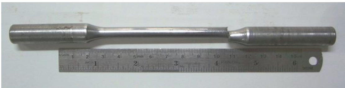
รูปที่ 15 ชิ้นทดสอบความแข็งแรงดึงเหล็กกล้าผสมต่ำ AISI 4340 ทดสอบที่ 600 MPa ชั้นที่ 1
