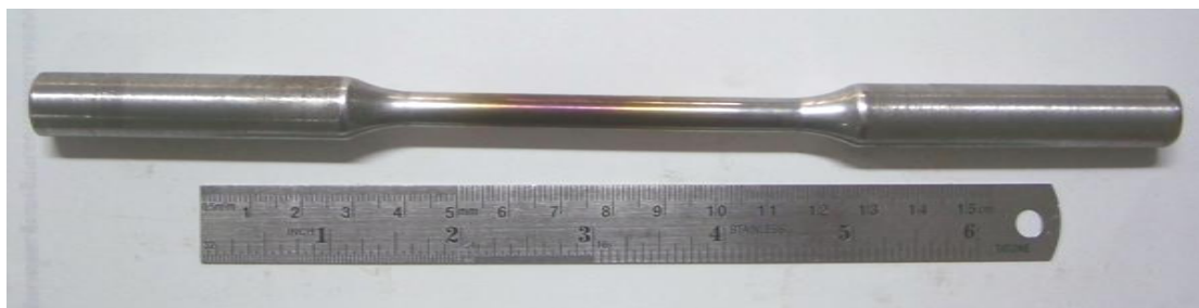
รูปที่ ง17 ชิ้นทดสอบความแข็งแรงล้าจากเนื้อเชื่อม MMA ทดสอบที่ 700 MPa ชั้นที่ 1
