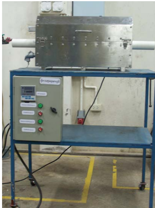
รูปที่ 2.5 ภาพเตาเผาอุณหภูมิสูงแบบท่อเสร็จสมบูรณ์
