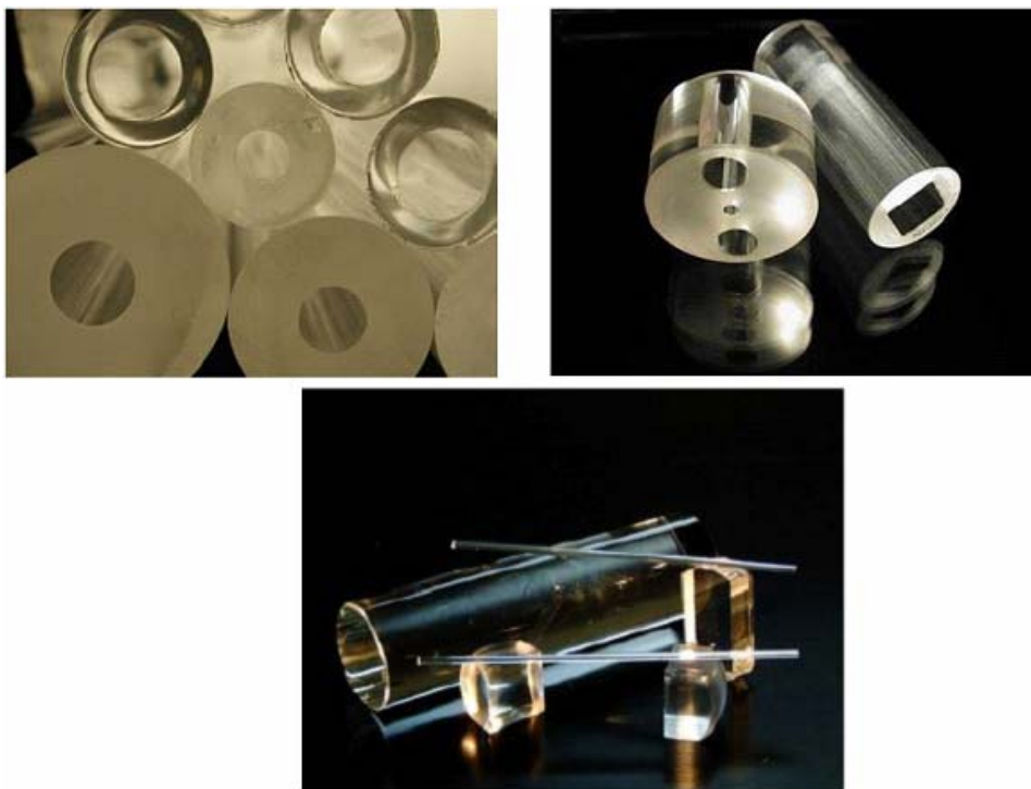
รูปที่ 1.6 ตัวอย่างผลิตภัณฑ์แก้วจากกระบวนการโซล-เจล
