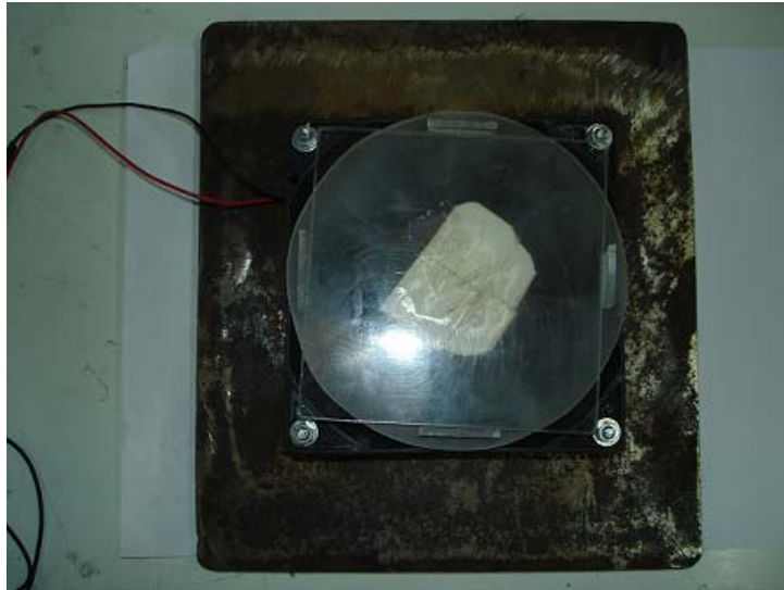
รูปที่ 2.5 เครื่องเคลือบแบบหมุนเหวี่ยง ความเร็วสูงสุด 1700 รอบต่อนาที
