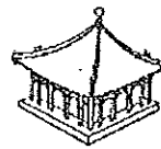
ภาพที่ 75 หลังคาแบบเก้งจีน
