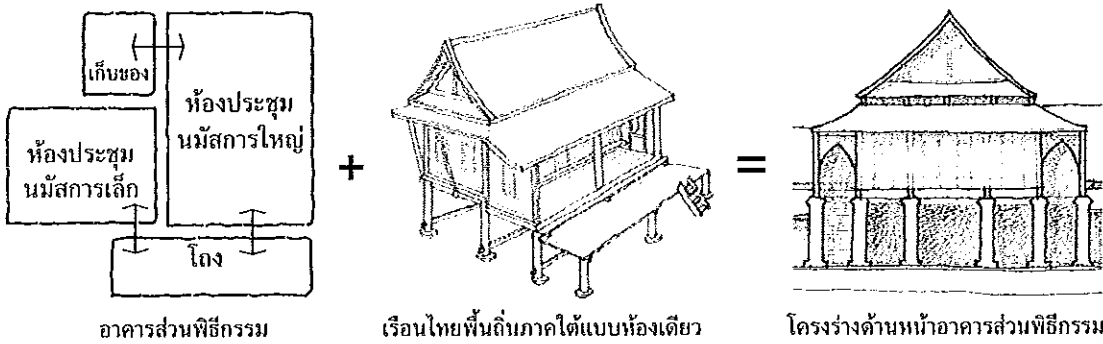
แผนภาพที่ 12 แสดงแนวคิดการออกแบบโครงร่างอาคารห้องประชุม นมัสการใหญ่ โดยนำสถาปัตยกรรมเรือนไทยพื้นถิ่นภาคใต้ แบบห้องเดียวมาปรับใช้ ทำเสาอาคารแบบตีนเสา ประดับหน้าจั่วหุ้มกลองด้วยไม้กางเขนแบบคริสเตียน ที่มา: ผู้วิจัย
