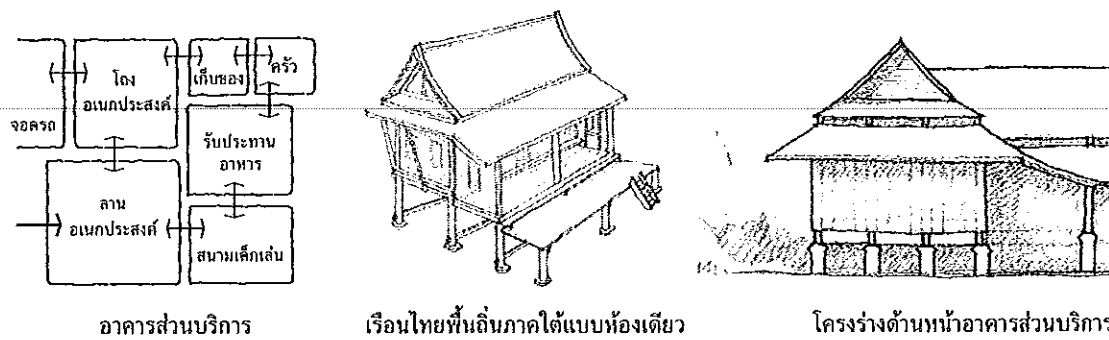
แผนภาพที่ 14 แสดงแนวคิดการออกแบบโครงร่างอาคารส่วนโถงอเนกประสงค์ โดยการนำรูปแบบสถาปัตยกรรมเรือนไทยพื้นถิ่น ภาคใต้แบบห้องเดียวมาปรับใช้ ที่มา: ผู้วิจัย
