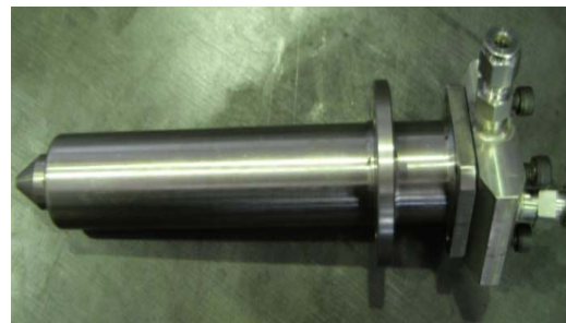
รูปที่ 2.5 ขนาดและลักษณะของหัวจ่ายน้ำโลหะที่ได้จัดทำขึ้น
