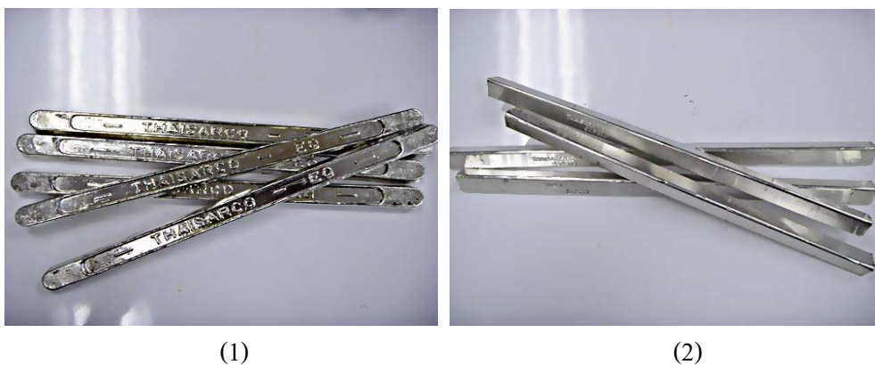
รูปที่ 2.17 วัตถุดิบที่ใช้ในการทดลอง 1) แท่งดิบ และ 2) แท่งโลหะบัดกรี SAC 305
