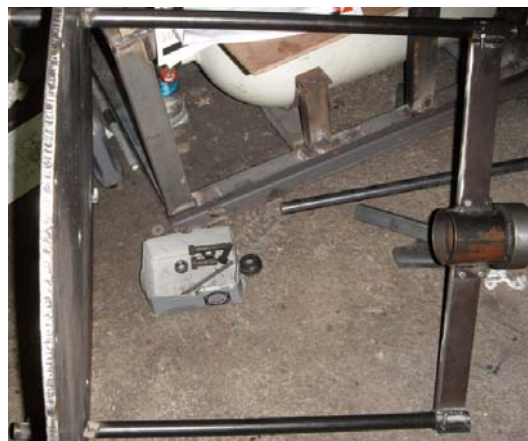
รูปที่ 2.12 ตัวจับยึดเครื่องอัลตราโซนิกภายในถังอะตอมไมเซอร์ที่ได้จัดทำขึ้น
