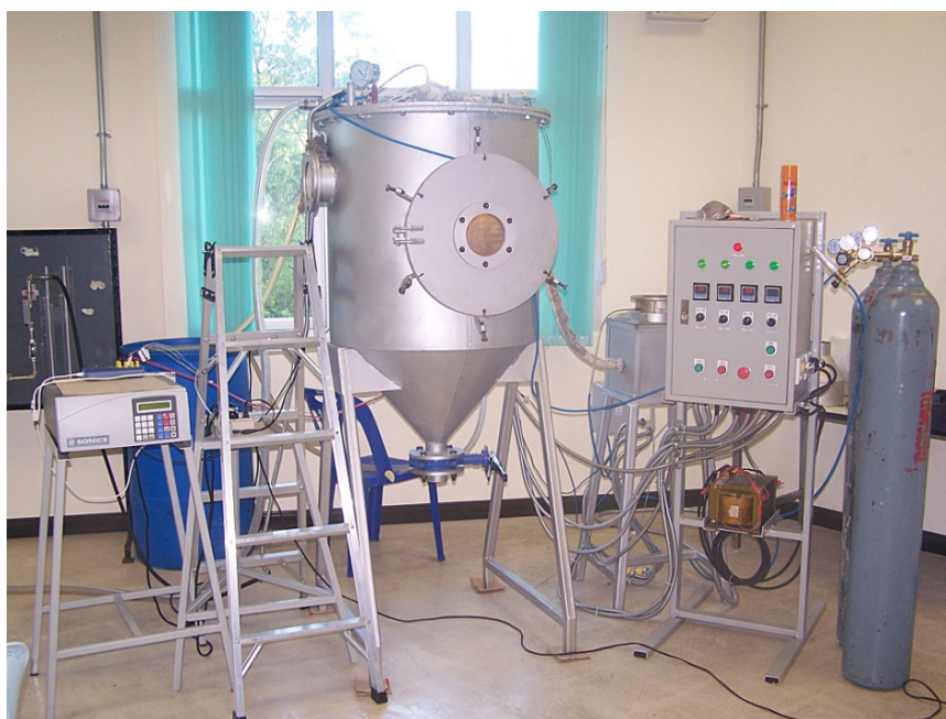
รูปที่ 2.16 เครื่องอัลตราโซนิกอะตอมไมเซชันที่ได้จัดทำขึ้น
