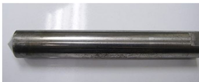
รูปที่ 2.10 ขนาดและลักษณะของอัลตราโซนิกโพรบที่ได้จัดทำขึ้น
